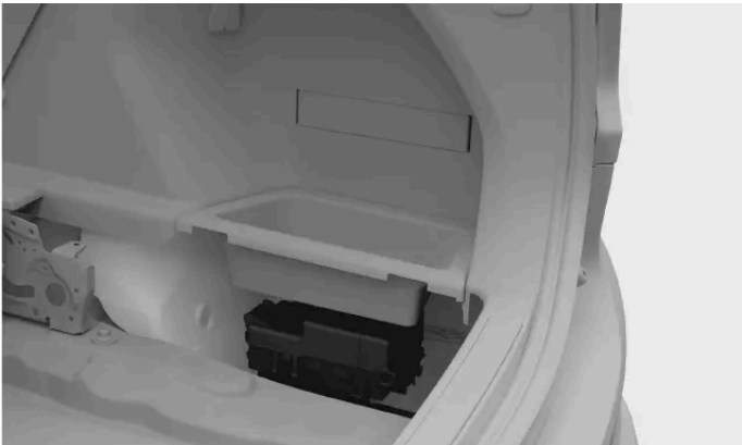
Emplacement de la boîte à fusibles
