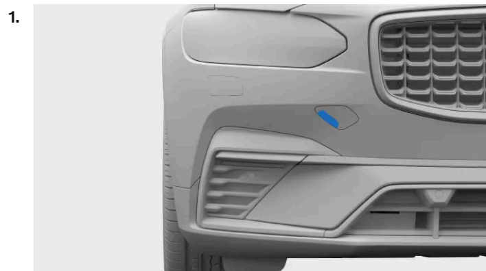
Cache de fixation d'anneau de remorquage avant
