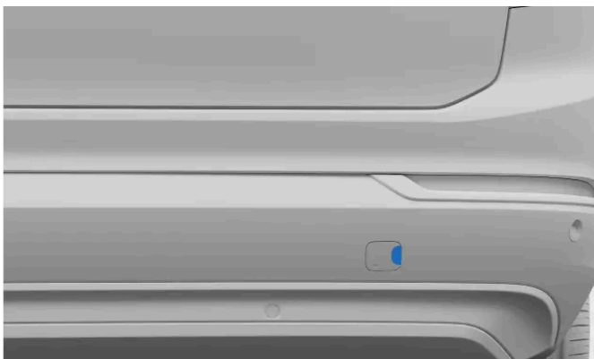
Cache de fixation d'anneau de remorquage arrière
