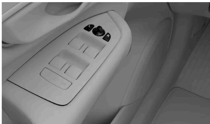
Commandes de réglage des rétroviseurs extérieurs
