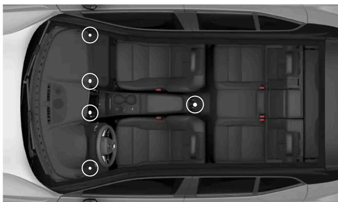
Position des buses de ventilation réglables
