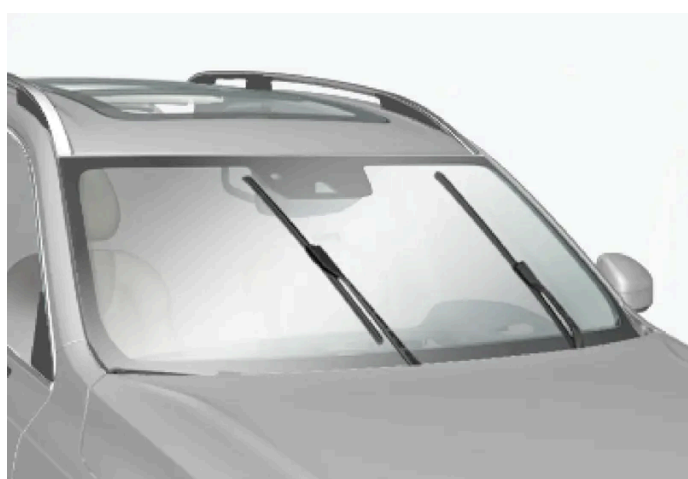
Balais d'essuie-glace en position d'entretien.
