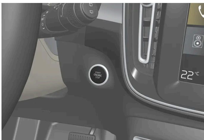
Emplacement de la commande de démarrage.
