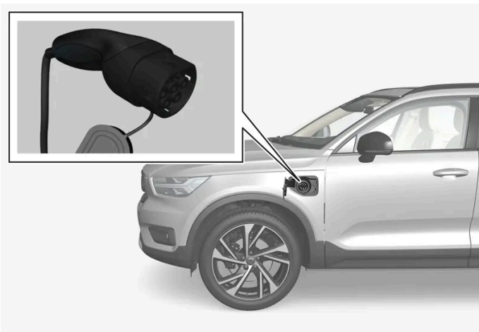
Poignée de câble de chargement et prise de chargement.
