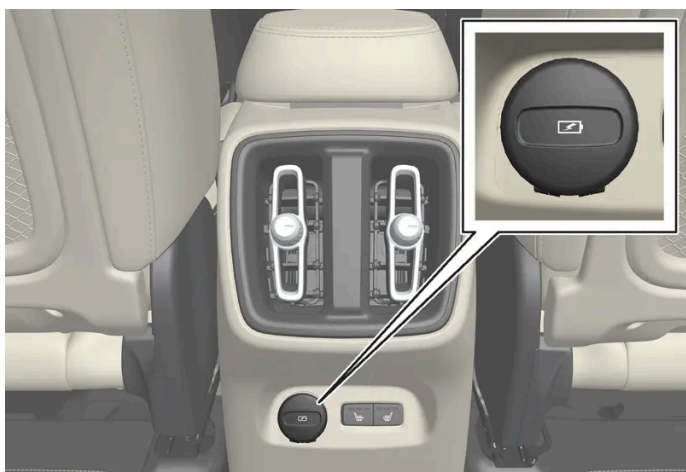
Ports USB* (type C) à l'arrière de la console de tunnel pour le chargement d'un téléphone ou d'une tablette, par exemple [1] .
