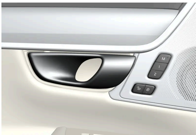
Poignée d'ouverture pour le déverrouillage alternatif d'une porte latérale [1] .
