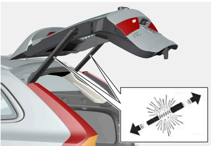
Les vérins du hayon à commande électrique.
