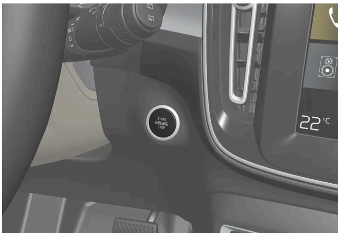
Emplacement de la commande de démarrage.
