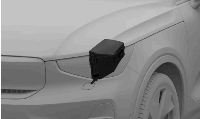
Emplacement de la boîte à fusibles
