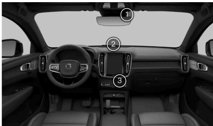
Capteurs intérieurs de climatisation
