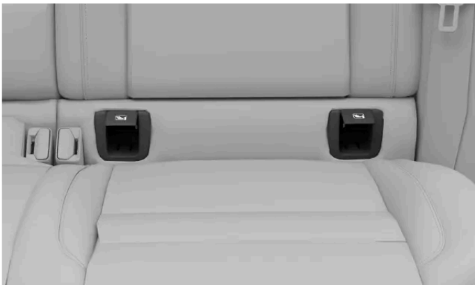
Position des points de fixation ISOFIX pour les sièges arrière extérieurs
