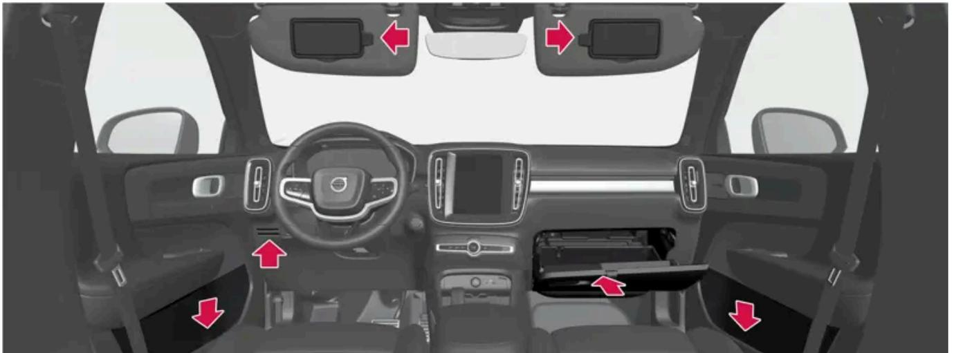
Compartiment de rangement dans le panneau de porte, porte-carte\* à côté du volant, pare-soleil et boîte à gants avec crochet escamotable.
