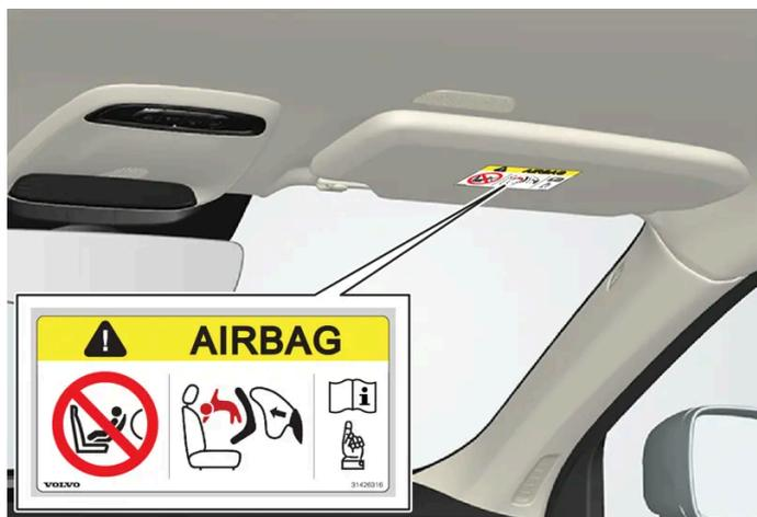
Autocollant sur le pare-soleil du côté passager.
