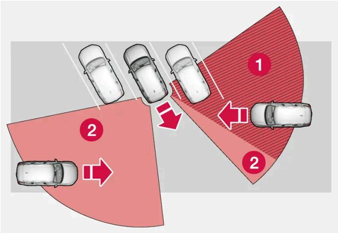
Dans un espace de stationnement en épis, le champ de détection des capteurs peut être entièrement bloqué d'un côté.
