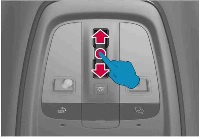
Faites glisser votre doigt de façon régulière et continue vers l'arrière/l'avant sur la commande tactile pour ouvrir/fermer complètement le toit panoramique. En cas de problème, effectuez le mouvement plus lentement ou plus rapidement.
