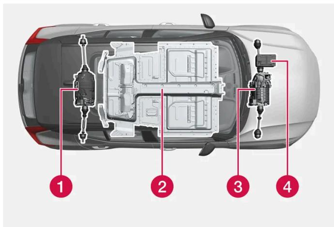
**1** Moteur électrique<sup>[1]</sup> – La voiture comporte deux moteurs électriques qui propulsent la voiture et transforment l'énergie de freinage en énergie électrique.
