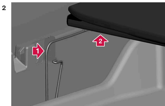
➡ Appuyez sur le ressort de verrouillage à l'endroit indiqué par la flèche jusqu'à la butée. Maintenez enfoncé.
