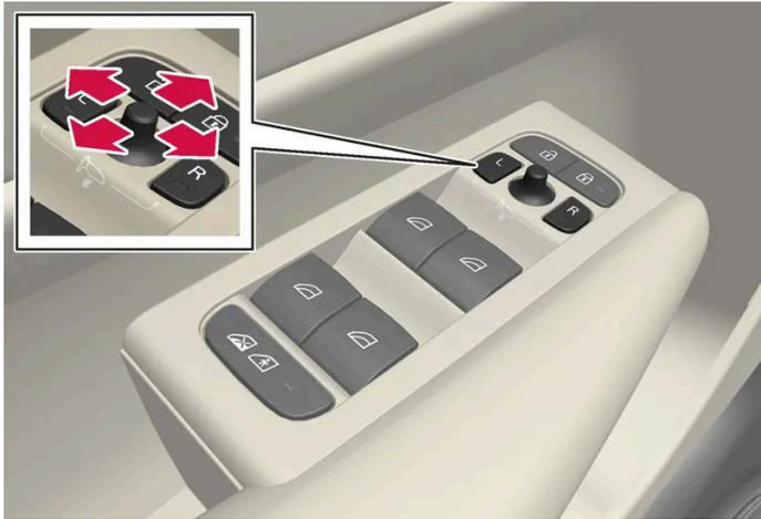
Commande des rétroviseurs extérieurs.
