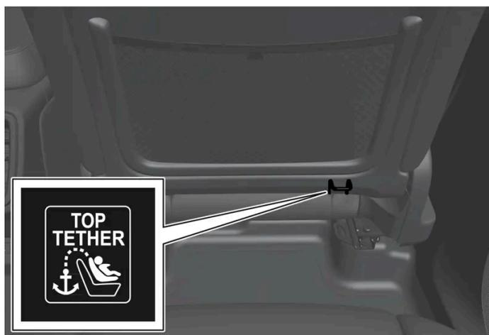
La position du point de fixation pour le siège avant est indiquée par un symbole sur la face arrière du siège avant.
