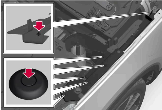
Position des bouchons du panneau B ; le panneau C est placé symétriquement par rapport au panneau B
