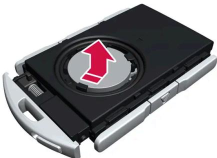
Le côté (+) de la pile est placé vers le haut. Pour déloger la pile, appuyez sur le bord puis sortez-la.
