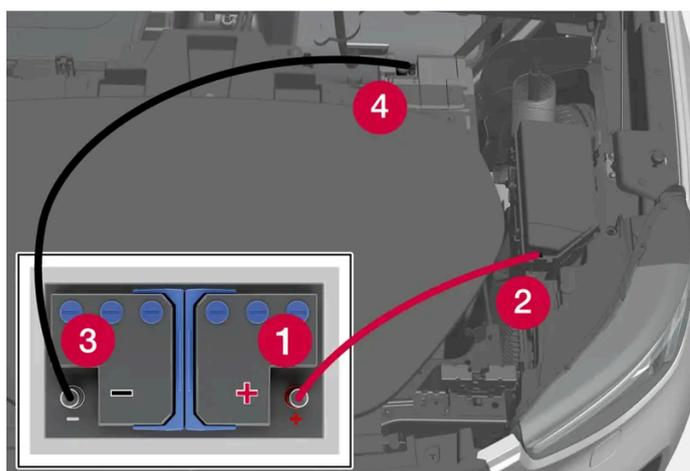
Pour accéder aux points de recharge sous le capot, plusieurs panneaux entourant le compartiment de rangement doivent être détachés.
