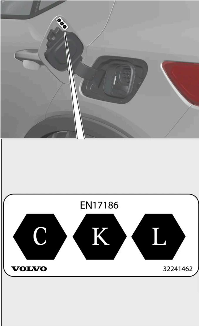
Un identifiant conforme à la norme CEN EN 17186 figure sur l'intérieur de la trappe de recharge.
