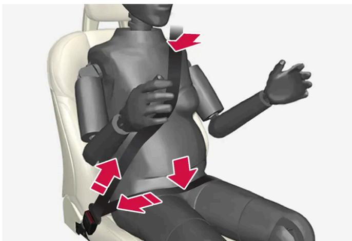
La ceinture de sécurité doit se coller contre l'épaule et la partie diagonale doit se placer entre les seins et sur le côté du ventre.
