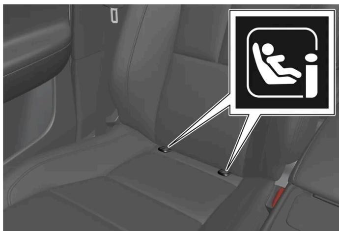
L'emplacement des points de fixation pour le siège avant est indiqué par des symboles sur la garniture du dossier.
