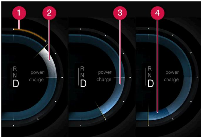
La jauge de puissance est placée à droite dans l'écran conducteur.
