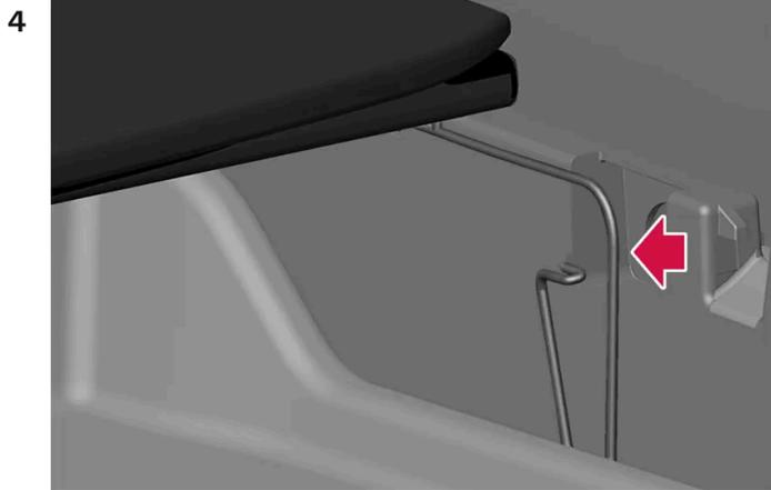
Tenez le plancher soulevé et appuyez sur le ressort de verrouillage de l'autre côté, à l'endroit indiqué par la flèche.
