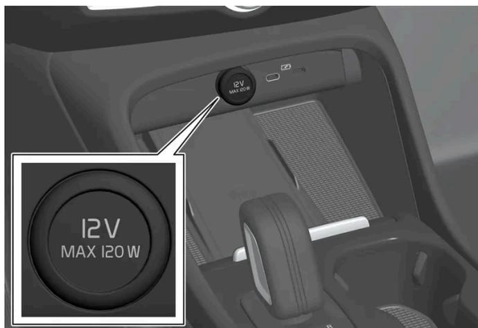
Prise électrique 12 V sur la console de tunnel, sièges avant.
