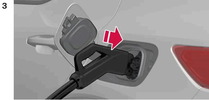
Empoignez le câble de recharge à deux mains et enfoncez-le à fond dans la prise de recharge de la voiture. Tenez la prise de recharge pendant quelques secondes. Le câble de recharge se verrouille automatiquement dans la prise de recharge au bout de quelques secondes. Assurez-vous que le câble de recharge est bien verrouillé pour que la recharge puisse commencer.
