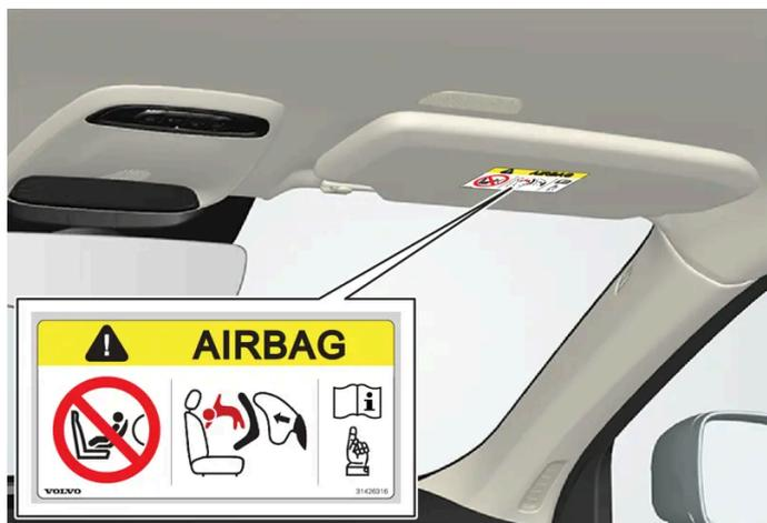
Autocollant sur le pare-soleil du côté passager.
