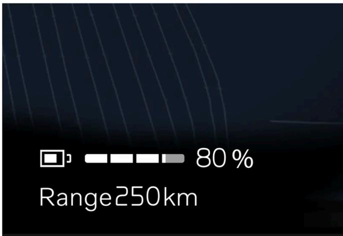
La jauge de batterie dans la partie inférieure de l'écran conducteur indique le degré de charge de la batterie à haute tension. Lorsque l'autonomie restante est inférieure à 50 km (30 miles), cela est indiqué à côté de la jauge de batterie. L'autonomie peut être affectée par des facteurs tels que le style de conduite et la température.
