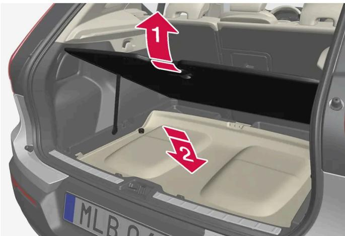
La plage arrière décrochée peut être rangée sous le plancher du compartiment à bagages.
