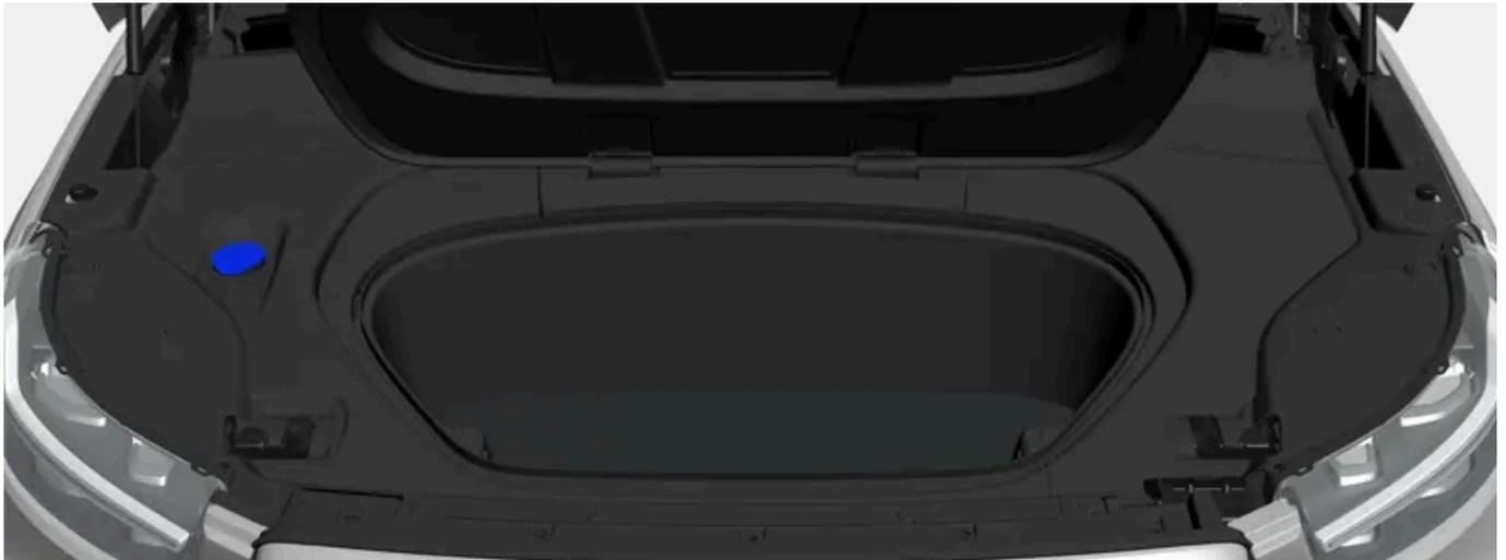
Un emplacement supplémentaire de rangement se trouve sous le capot. Le compartiment à bagages contient également l'œillet de remorquage et le kit de réparation de crevaison de la voiture.
