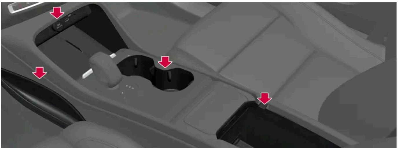
Compartiment de rangement dans l'espace pour les jambes, prise électrique et ports USB au-dessus du chargeur sans fil de téléphone\*, porte-gobelets et rangement sous l'accoudoir de la console de tunnel.
