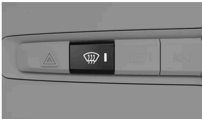
Bouton de dégivrage maximal sur le panneau de boutons en dessous de l'écran central
