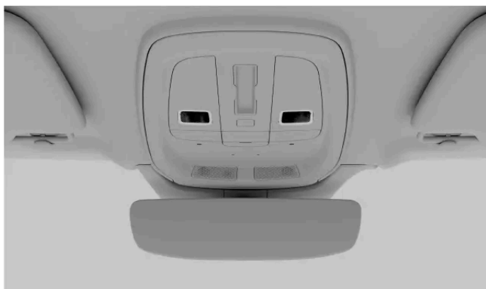
Liseuses à l'avant dans la console au plafond
