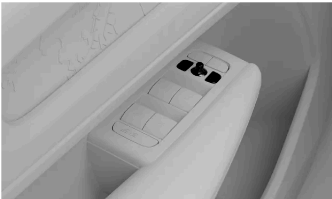
Commandes de réglage des rétroviseurs extérieurs
