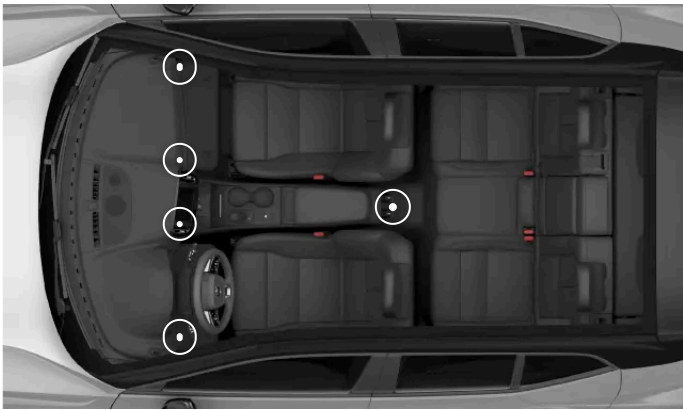
Position des buses de ventilation réglables
