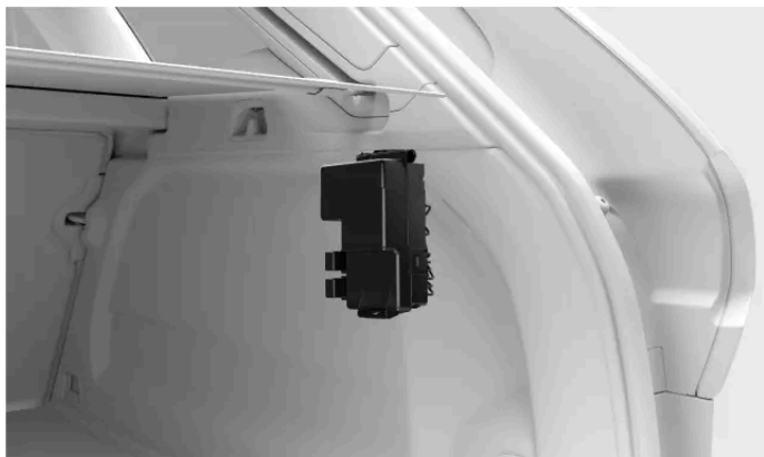
Emplacement de la boîte à fusibles
