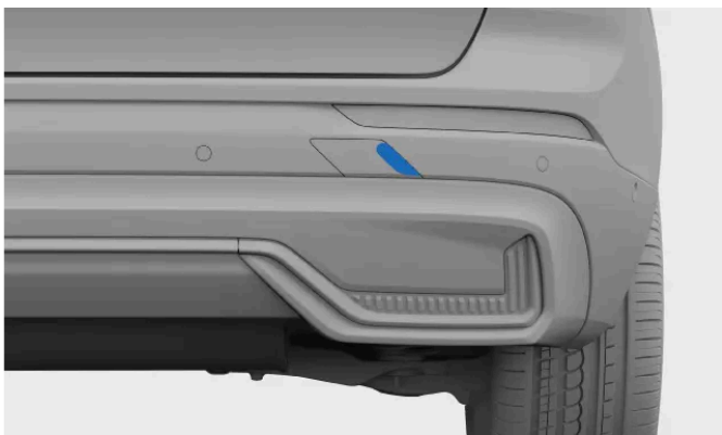
Cache de fixation d'anneau de remorquage arrière
