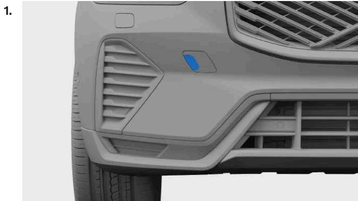
Cache de fixation d'anneau de remorquage avant
