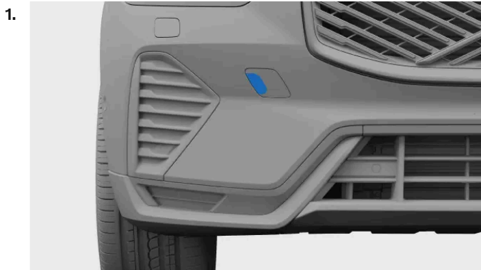
Cache de fixation d'anneau de remorquage avant
