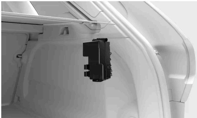
Emplacement de la boîte à fusibles
