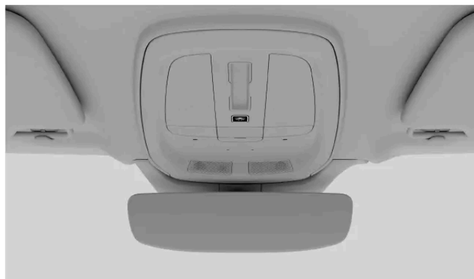
Bouton d'extinction automatique des lampes sur la console au plafond
