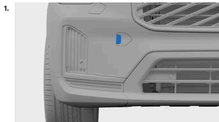
Cache de fixation d'anneau de remorquage avant
