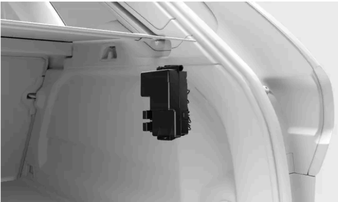
Emplacement de la boîte à fusibles
