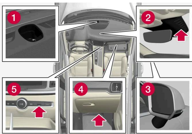
① Capteur d'ensoleillement - sur la partie supérieure du tableau de bord.
