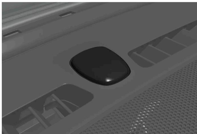
Le témoin de verrouillage et d'alarme est placé au centre du tableau de bord, près du pare-brise.
