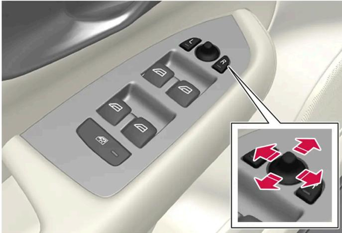
Commande des rétroviseurs extérieurs.
