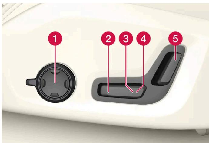
L'illustration montre les commandes sur une voiture à soutien lombaire quadridirectionnel\*. Les voitures à soutien lombaire bidirectionnel\* ne disposent pas de la commande multifonction tournante.
