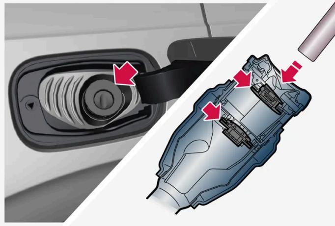
Il est essentiel d'insérer le bec du pistolet de pompe au-delà des deux clapets ouvrants du tuyau de remplissage avant de commencer le remplissage.
