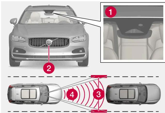
Les unités de caméra/radar mesurent la distance au véhicule qui précède et détectent les marquages au sol.
