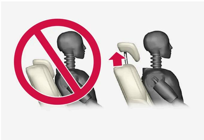
L'appuie-tête de la place centrale doit être ajusté selon la taille du passager de manière à couvrir l'ensemble de la partie arrière de la tête. Réglez l'appuie-tête manuellement selon vos besoins.
