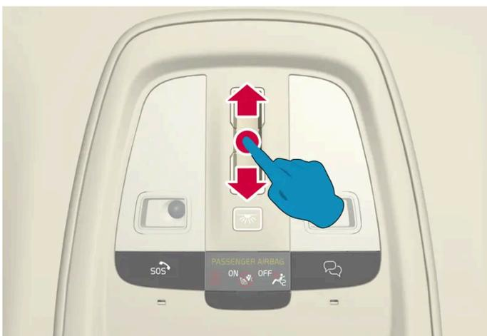
Faites glisser votre doigt de façon régulière et continue vers l'arrière/l'avant sur la commande tactile pour ouvrir/fermer complètement le toit panoramique. En cas de problème, effectuez le mouvement plus lentement ou plus rapidement.
