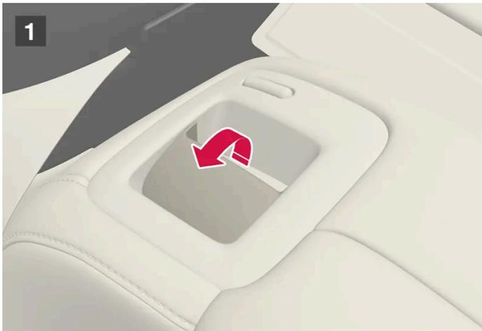
Sur les voitures équipées d'appuie-tête à rabattement à commande électronique\*, les appuie-tête extérieurs peuvent être rabattus à l'aide de la poignée sur le dessus de la banquette, voir **1**. Veuillez noter que cette méthode permet également de rabattre
