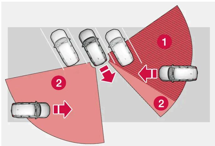
Dans un espace de stationnement en épis, le champ de détection des capteurs peut être entièrement bloqué d'un côté.
