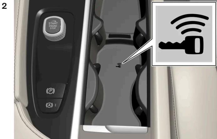
Placez la clé sur le symbole en forme de clé dans le lecteur de secours du porte-gobelet de rangement de la console du tunnel.
