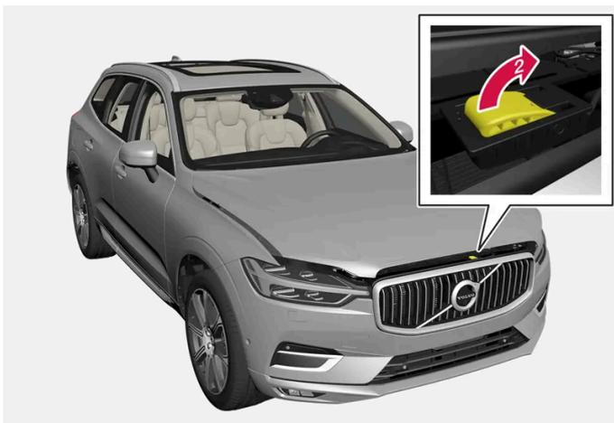
➔ Passez la main de la gauche vers la droite dans l'ouverture située sous le capot. Poussez la poignée vers le haut et sur le côté afin d'ouvrir le verrou puis soulevez le capot.
