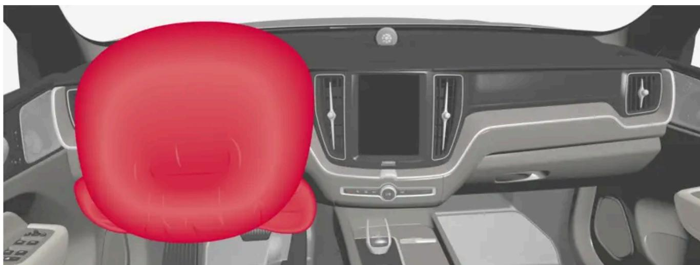
Coussin gonflable dans le volant et coussin gonflable de genoux<sup>[1]</sup> du siège avant, côté conducteur.
