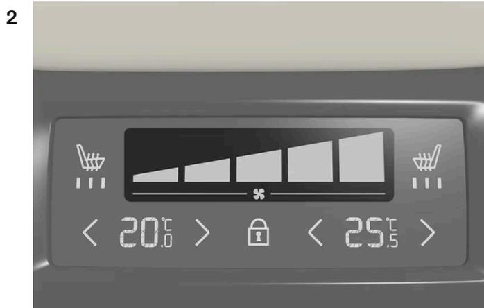
Commande de ventilateur sur le panneau de commandes climatiques arrière, sur la console de tunnel.
