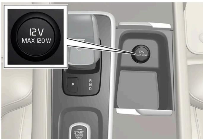
Prise électrique avant de console de tunnel pour voitures sans chargeur de téléphone par induction\*.
