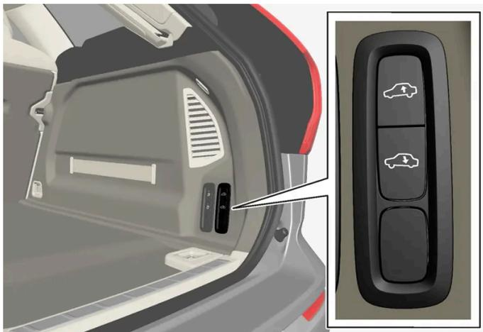
Utilisez les boutons dans le compartiment à bagages pour ajuster la hauteur de l'arrière de la voiture afin de faciliter le chargement et le déchargement ou pour atteler ou dételer une remorque.
