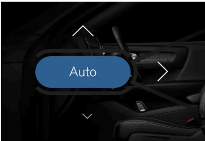
Bouton de régulation automatique de climatisation et flèches de répartition de l'air.
