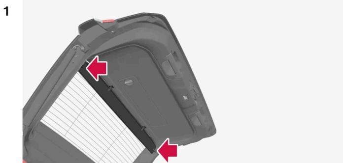
Orientez le cache correctement, avec la face comportant les vis vers le bas et insérez l'ergot dans la fixation sur un côté du hayon.
