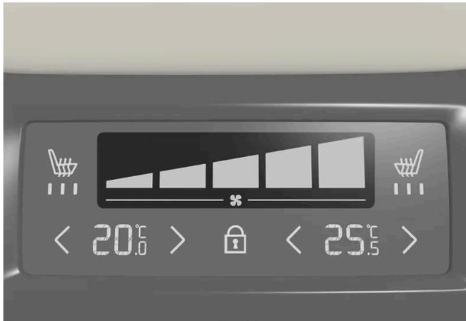
Commande de ventilateur sur le panneau de commandes climatiques arrière, sur la console de tunnel.
