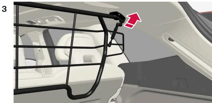
Placez les fixations de la grille de protection dans les fixations au plafond.
