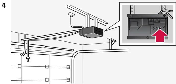
Cherchez le bouton d'apprentissage<sup>[2]</sup> sur le récepteur de la porte de garage par exemple. Il est généralement placé près de la fixation de l'antenne sur le récepteur.
