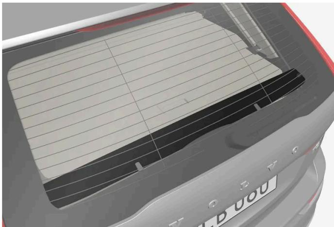
Un cache doit être monté sur le hayon lors de l'utilisation du cache-bagages.
