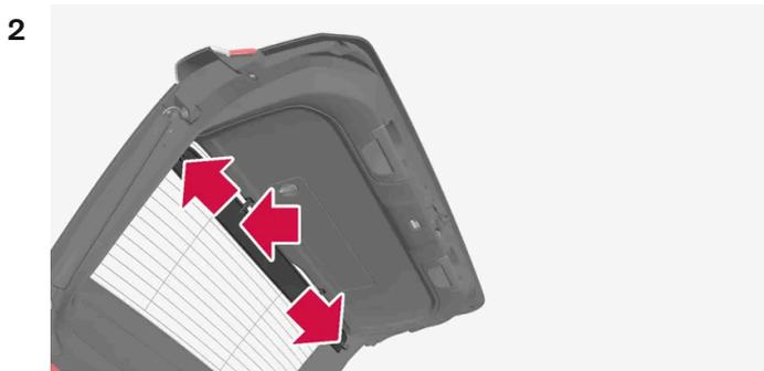
Retirez doucement le cache de l'un des fixations latérales du hayon puis de l'autre côté. Vous pouvez aussi appuyez légèrement sur le cache pour faciliter la dépose.
