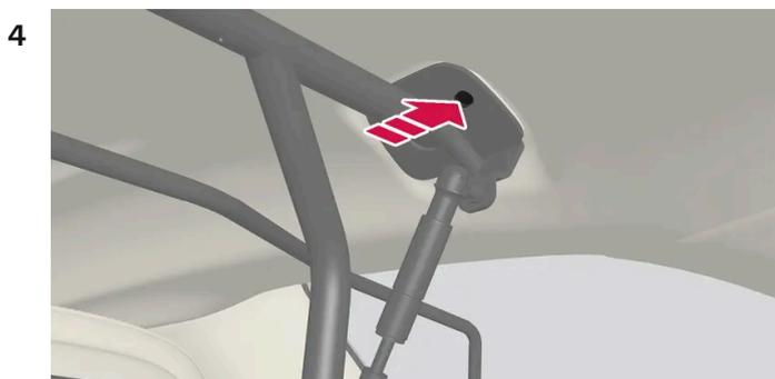
Montez la vis fournie et serrez, une clé de 6 mm est fournie. Répétez la procédure de l'autre côté. Couple de serrage recommandé : 20 Nm (15 pied-livre).
