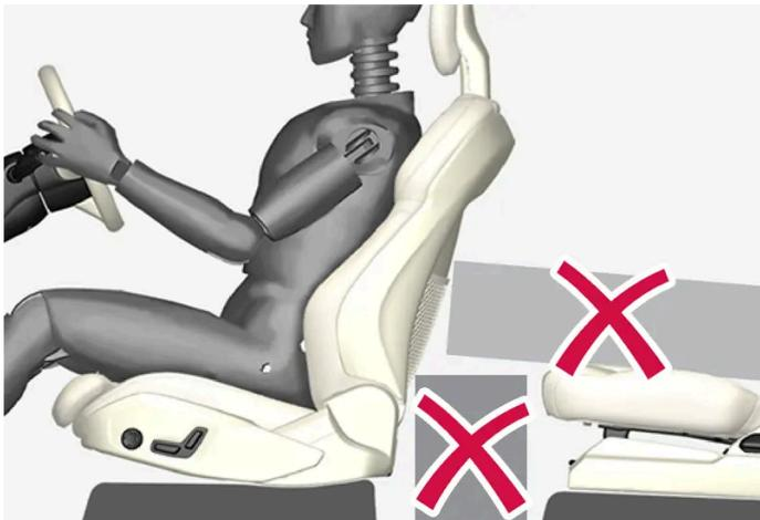
Ne placez jamais d'objets sur le plancher derrière ou sous les sièges avant ou la banquette arrière qui pourraient gêner le fonctionnement du système WHIPS.
