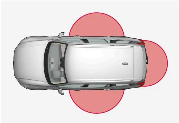
Pour les fonctions sans clé, une clé doit se trouver à une distance de 1 à 1,5 mètre (3 à 5 pieds) environ des portes ou du hayon de la voiture.
