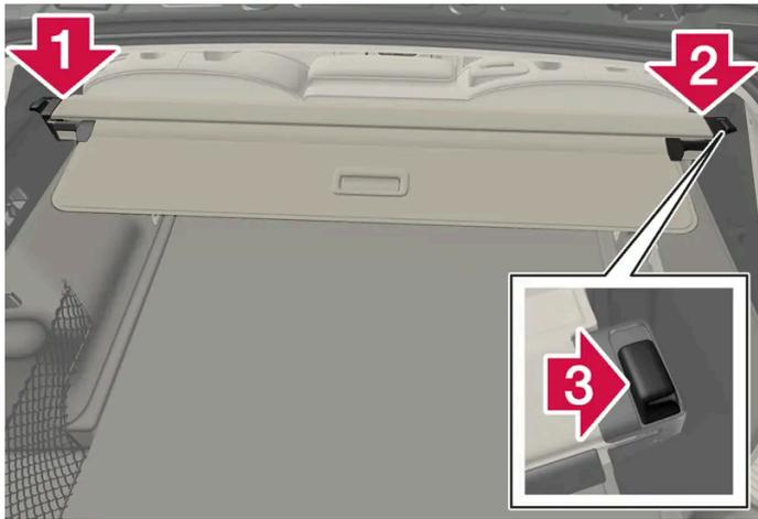
1 Placez l'une des extrémités du cache-bagages dans la fixation du panneau latéral du compartiment à bagages.
