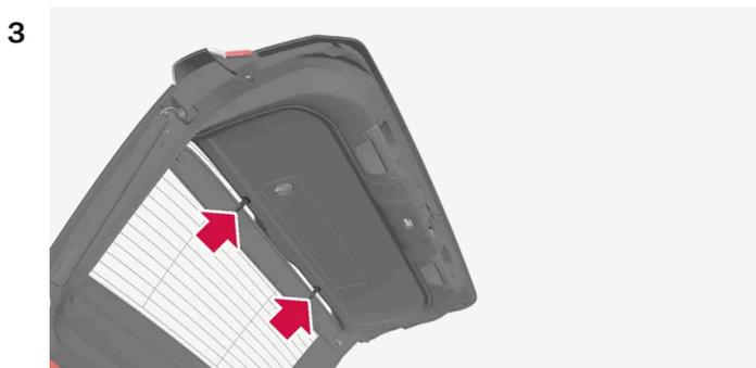
Enfoncez les deux attaches supérieures dans les encoches correspondantes du hayon afin de les fixer.
