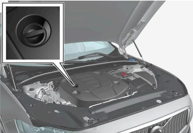
Tuyau de remplissage<sup>[1]</sup> <sup>[2]</sup>
