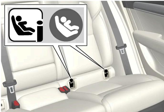
La position des points de fixation pour la banquette arrière est indiquée par des symboles<sup>[1]</sup> sur les caches qui dissimulent les points de fixation.
