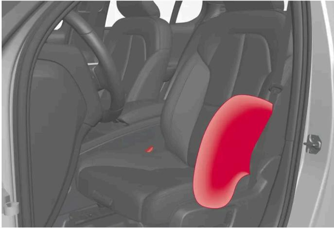
Les coussins gonflables latéraux extérieurs sont montés dans les cadres extérieurs des dossiers des sièges avant et aident à protéger le conducteur et le passager des sièges avant.
