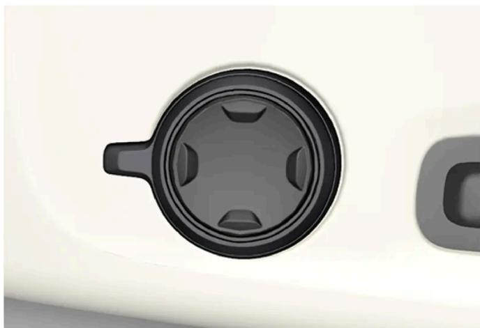
La commande multifonctions, sur les voitures à soutien lombaire quadrirectionnel\*.
