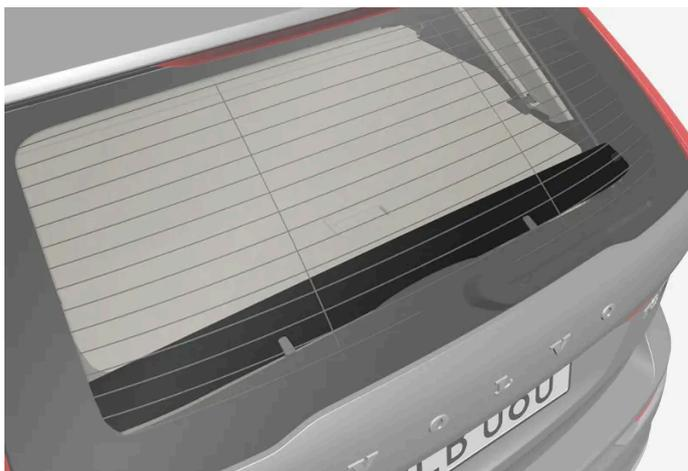
Le plateau arrière monté sur l'intérieur du hayon complète le cache-bagages.
