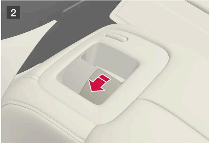
Sur les voitures sans rabattement électronique de la banquette arrière, les appuis-tête extérieurs se rabattent manuellement à l'aide de la commande intérieure située sur le siège (illustration 2).
