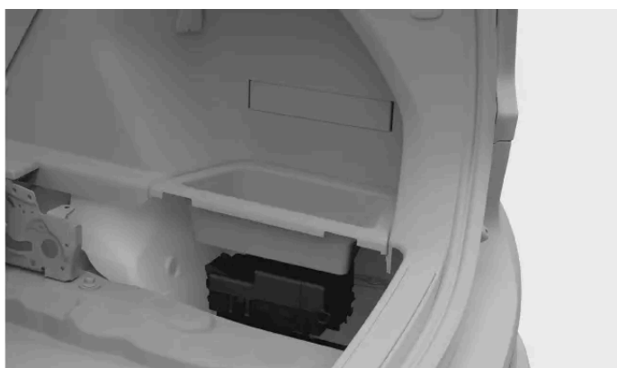
Emplacement de la boîte à fusibles
