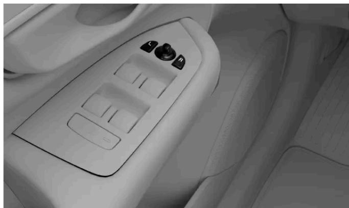
Commandes de réglage des rétrocaveirs extérieurs
