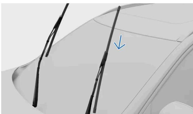
Vérifiez que le balai côté conducteur est plus long que celui du côté passager. Faites glisser le balai d'essuie-glace sur le bras d'essuie-glace. Vérifiez que la goupille du bras d'essuie-glace entre dans l'orifice du balai d'essuie-glace. Poussez le balai dans le bras d'essuie-glace jusqu'à ce qu'un déclic se fasse entendre.
