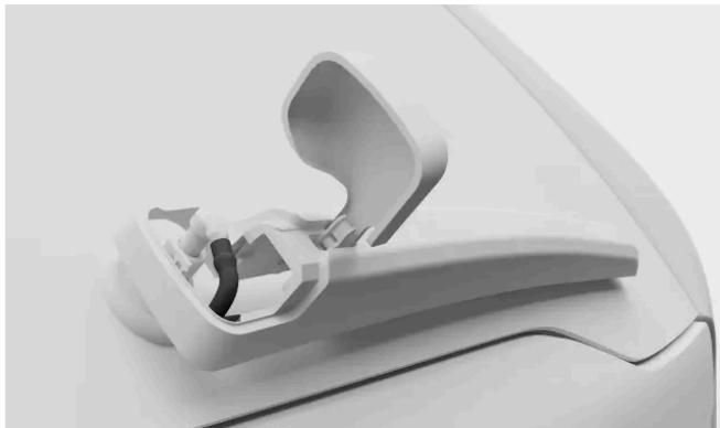
Trouvez le couvercle en plastique à l'endroit où le bras d'essuie-glace est fixé à la voiture. Détachez en premier le côté du couvercle le plus proche puis le côté le plus éloigné de vous. Soulevez entièrement le couvercle en plastique. Cela vous donnera accès au raccord de flexible.
