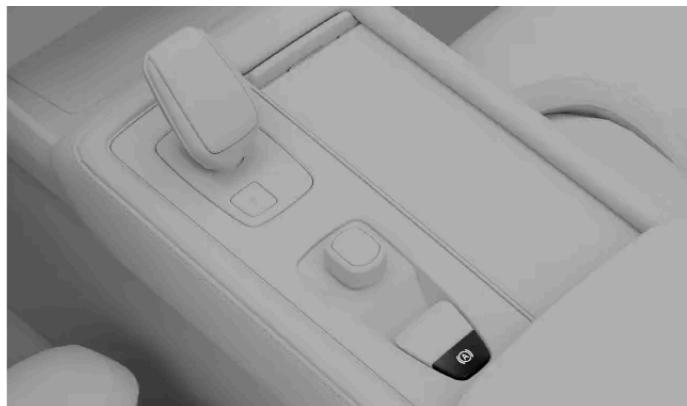
**1** Appuyez sur le bouton de Frein à l'arrêt sur la console de tunnel.
