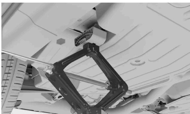
**9** Soulevez la voiture à une hauteur appropriée. Ne la soulevez pas plus que nécessaire pour les travaux à effectuer.
