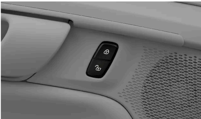
Bouton de la porte avant pour le verrouillage central
