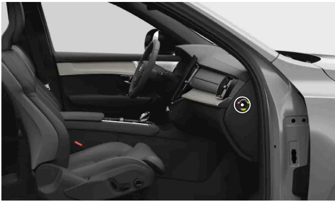
Position de l'interrupteur de coussin gonflable passager
