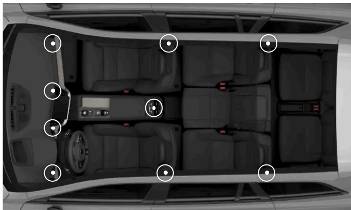
Position des buses de ventilation réglables
