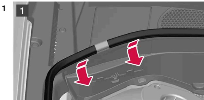
Levez la baguette en caoutchouc en la pressant vers le compartiment moteur.
