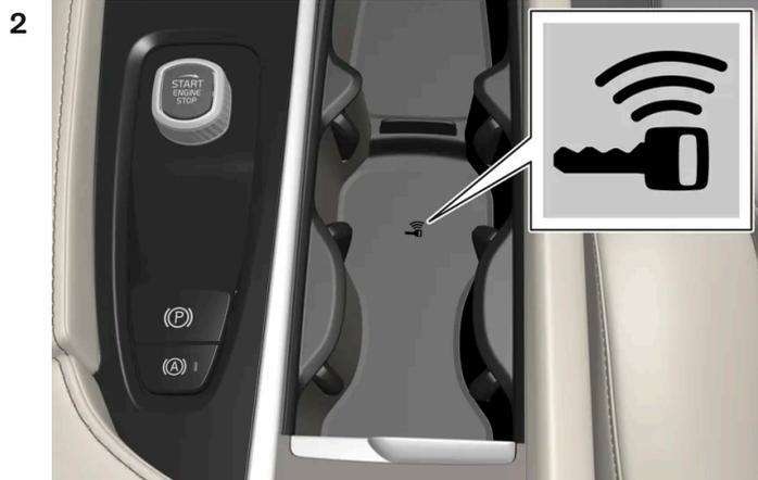
Placez la clé sur le symbole en forme de clé dans le lecteur de secours du porte-gobelet de la console du tunnel.
