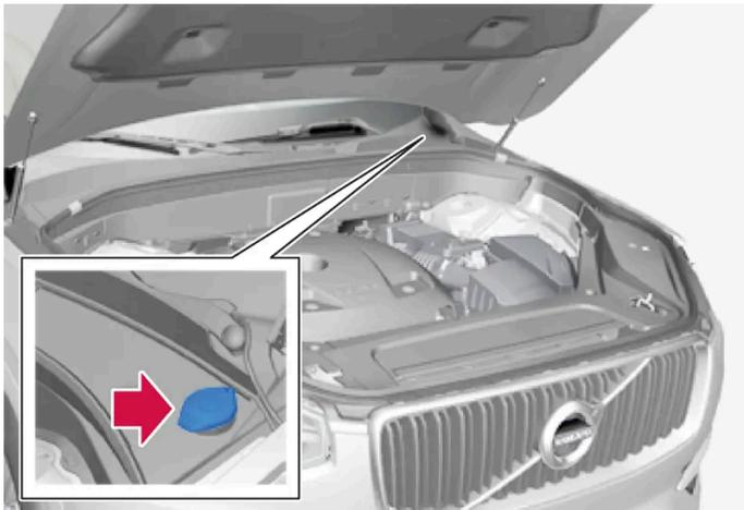
L'appoint en liquide lave-glace se fait dans le réservoir à bouchon bleu. Le réservoir est utilisé pour le lave-glace de pare-brise et lunette arrière ainsi que pour les lave-phares\*.
