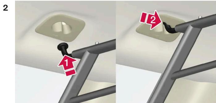
Insérez l'un des crochets de la grille de protection dans la grosse ouverture de la fixation du toit (1).
