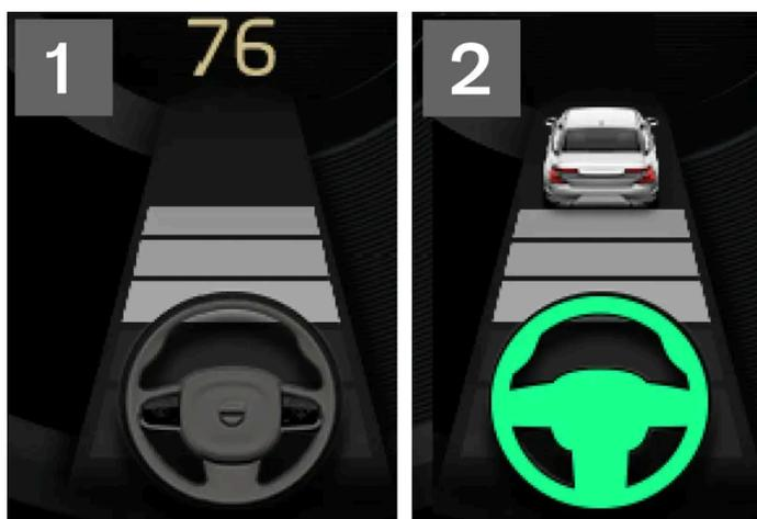
**2** Lorsque le symbole de volant sur l'écran conducteur est allumé, la fonction Pilot Assist est active.
