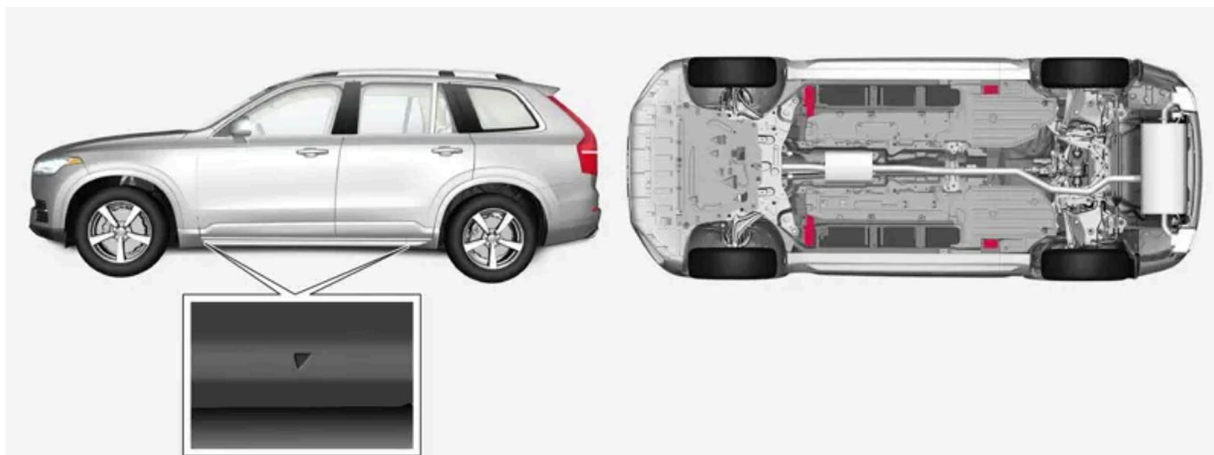
Les flèches le long du bord inférieur sur le côté de la voiture indiquent les emplacements des fixations pour cric/points de levage (en rouge).
