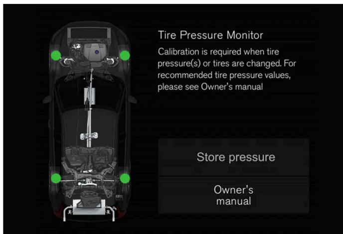
L'illustration est schématique. L'aspect réel peut varier selon le modèle de voiture ou si le logiciel est mis à jour.
