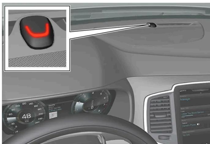
Une diode rouge sur le tableau de bord indique l'état du système d'alarme :
