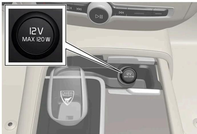
Prise électrique avant de console de tunnel pour voitures avec chargeur sans fil de téléphone\*.
