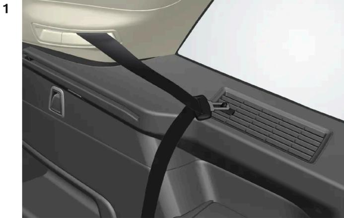
Accrochez les boucles des ceintures de sécurité des sièges de la troisième rangée aux crochets prévus à cet effet situés sur les panneaux latéraux.
