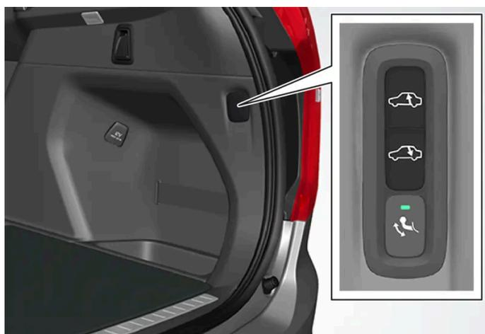
Utilisez les boutons dans le compartiment à bagages pour ajuster la hauteur de l'arrière de la voiture afin de faciliter le chargement et le déchargement ou pour atteler ou déteiler une remorque.
