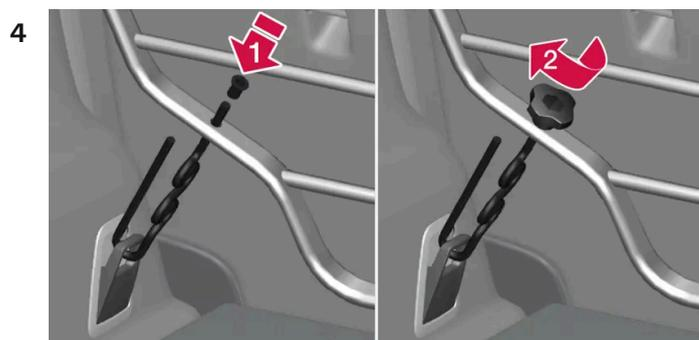
Fixez le crochet de l'étrier de fixation par dessous dans l'anneau d'arrimage de charge au niveau du plancher puis insérez la partie filetée par dessous dans l'ouverture de fixation inférieure de la grille de protection (1).
