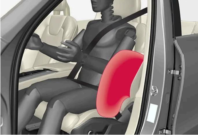
Les coussins gonflables latéraux sont montés dans les cadres extérieurs des dossiers des sièges avant et aident à protéger le conducteur et le passager des sièges avant.
