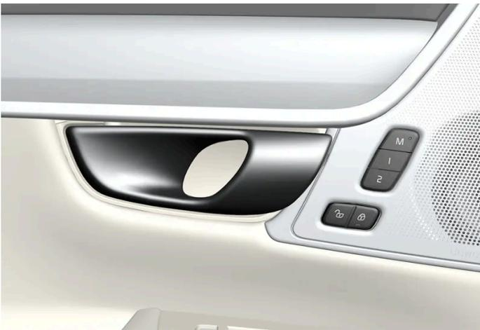
Poignée d'ouverture pour le déverrouillage alternatif d'une porte latérale<sup>[1]</sup>.
