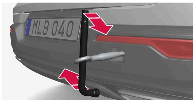
Vissez fermement l'œillet. Utilisez par exemple la clé à boulon de roue\* pour vous aider.
