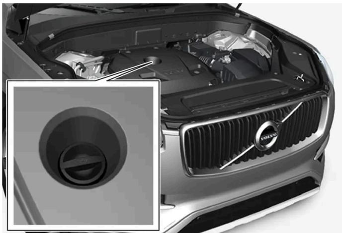
Tuyau de remplissage<sup>[1]</sup>, <sup>[2]</sup>
