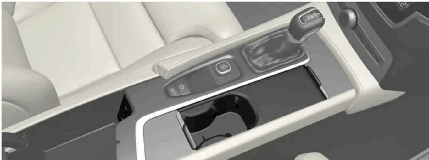
Compartiments de rangement avec porte-gobelets, chargeur sans fil de téléphone\*, prise électrique et ports USB dans la console tunnel.
