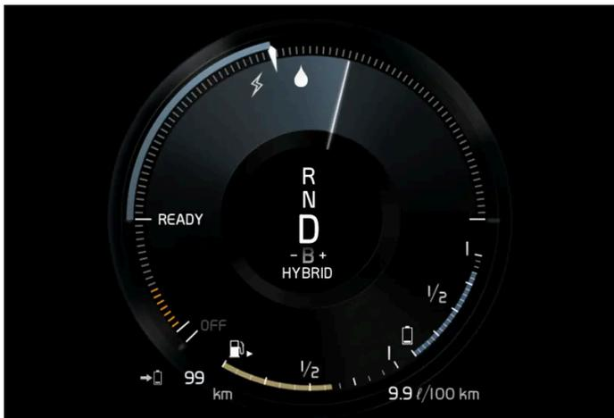
Le moteur électrique ne peut délivrer la puissance moteur demandée et le moteur à combustion démarre.
