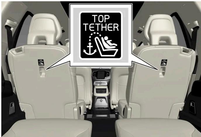
Variante à six sièges : L'emplacement des points de fixation pour la deuxième rangée de sièges est indiqué par des symboles sur la face arrière du dossier.
