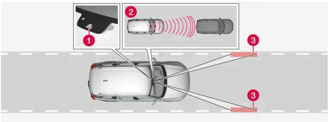
L'unité de caméra/radar mesure la distance au véhicule qui précède et détecte la signalisation au sol.
