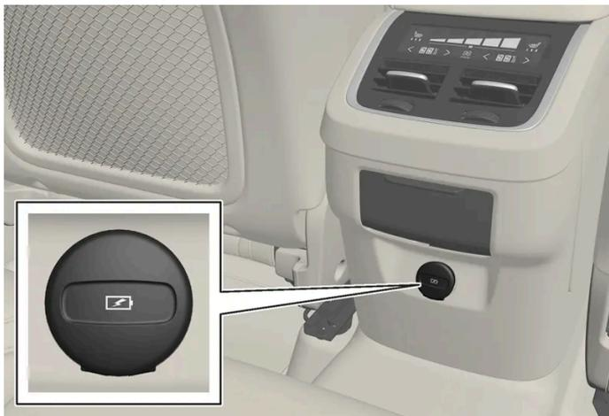
Ports USB (type C) à l'arrière de la console de tunnel pour le chargement d'un téléphone ou d'une tablette, par exemple<sup>[1]</sup>.
