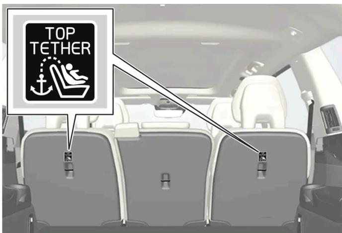
Variante à cinq et sept sièges : L'emplacement des points de fixation pour la deuxième rangée de sièges est indiqué par des symboles sur la face arrière du dossier.
