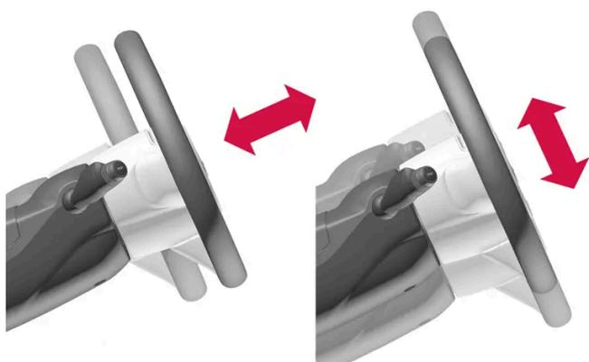
Le volant peut être réglé en profondeur et en hauteur.
