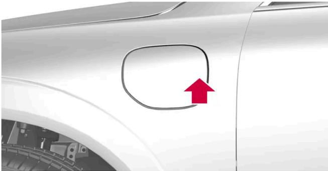
Appuyez sur la partie arrière de la trappe de recharge pour l'ouvrir et retirez le cache de la prise de recharge<sup>[2]</sup>.
