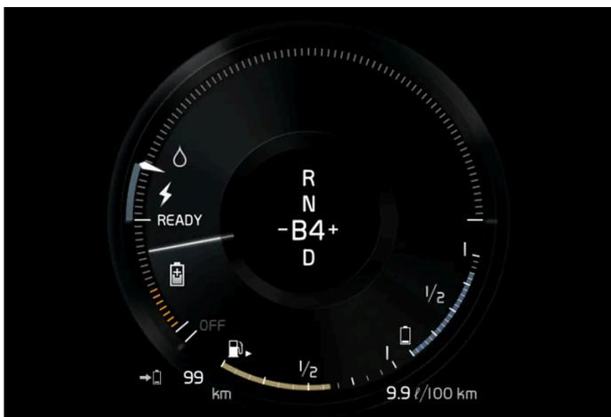
La voiture génère de l'énergie à la batterie et la batterie se recharge, lors d'une légère pression sur la pédale de frein ou d'un freinage moteur en descente par exemple.
