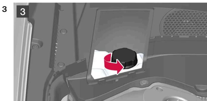
Dévissez le bouchon du vase d'expansion et faites l'appoint en liquide de refroidissement si nécessaire. Le niveau du liquide de refroidissement doit se trouver entre les repères MIN et MAX du vase d'expansion.
