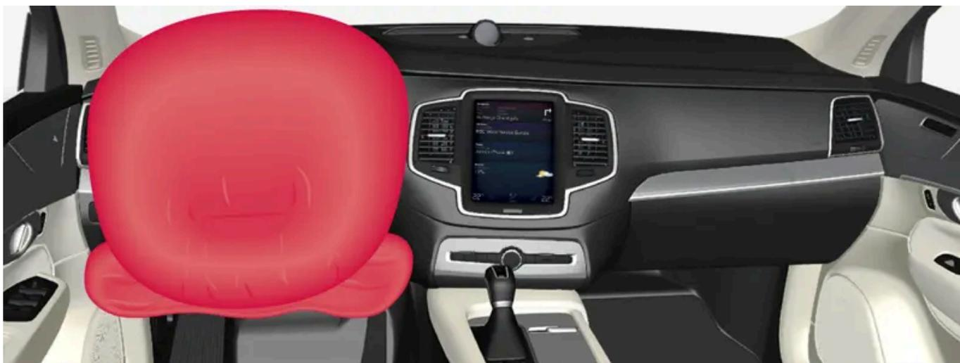
Coussin gonflable dans le volant et coussin gonflable de genoux du siège avant, côté conducteur.
