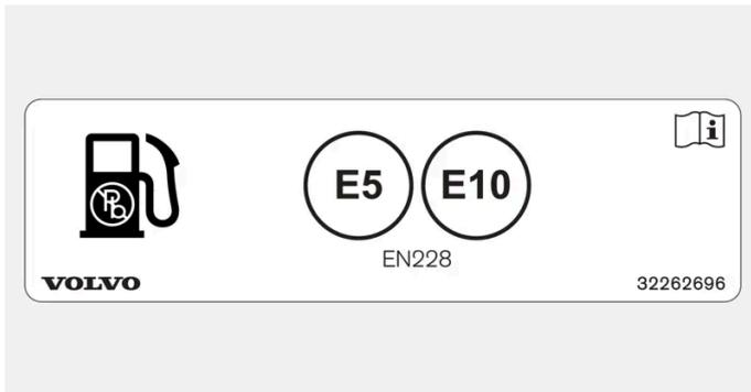
Autocollant à l'intérieur de la trappe de réservoir.
