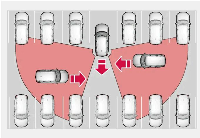
Exemple de zone où Cross Traffic Alert peut aider le conducteur à détecter un obstacle en marche arrière.
