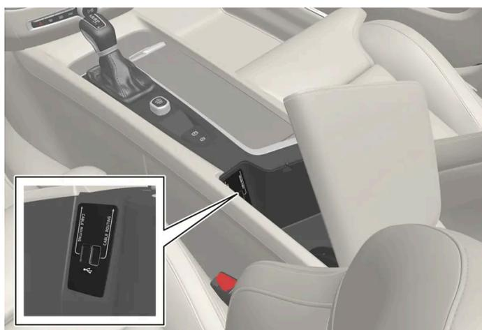
Ports USB (type A) de la console de tunnel. Vérifiez que le câble est en avant afin de ne pas le coincer en fermant la trappe.
