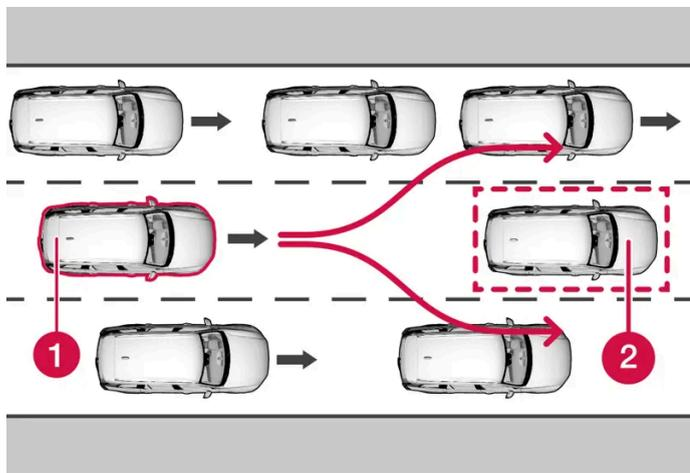
Le véhicule (1) ne "voit" aucune possibilité d'éviter le véhicule qui précède (2) et freine automatiquement par anticipation.
