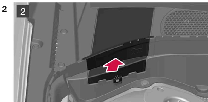
Libérez la trappe du cache en plastique en déployant le crochet de verrouillage et en tournant la trappe vers le haut.
