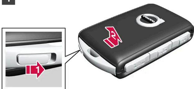
Glissez le verrou à côté de l'anneau d'attache vers le côté et glissez la coque de la partie avant dans le sens opposé de l'anneau.
