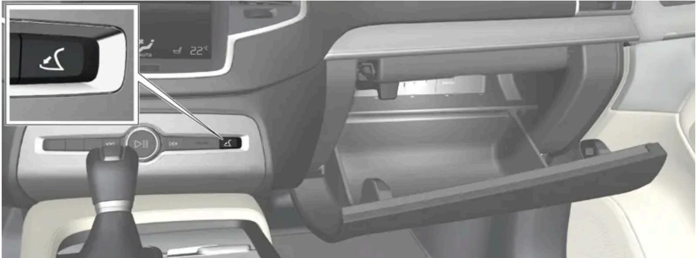
L'ouverture de la boîte à gants est commandée par une pression sur le bouton situé sur la console centrale.
