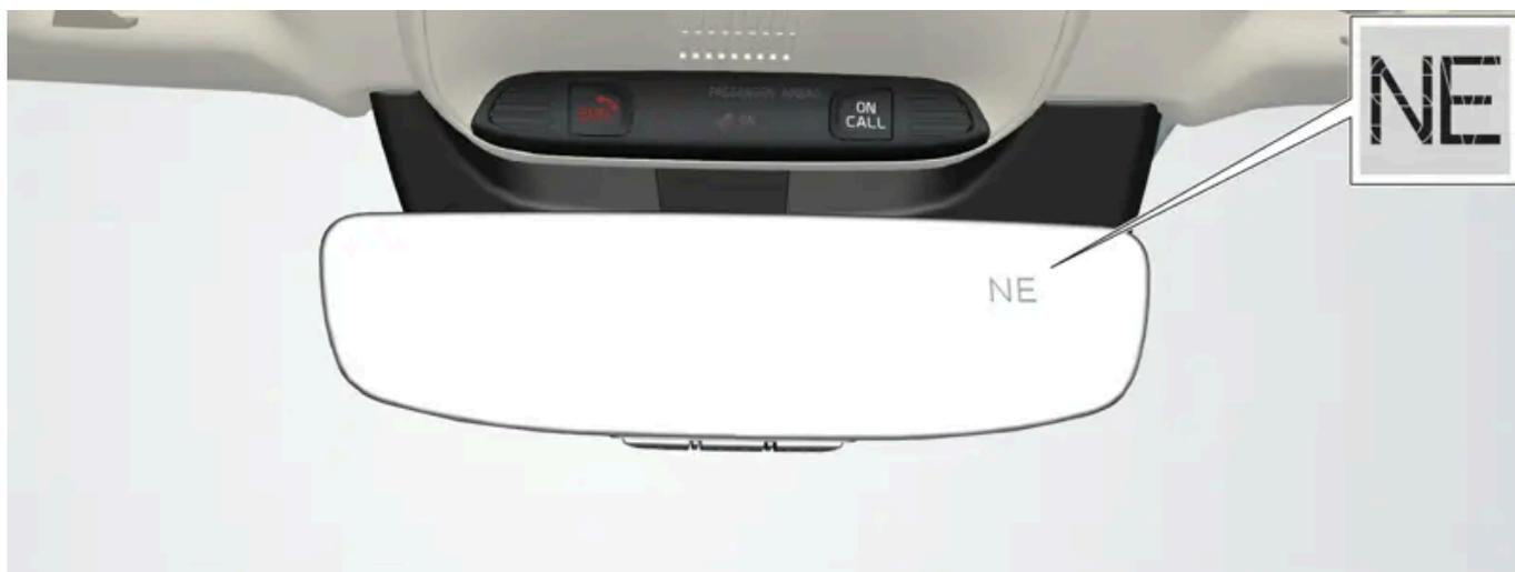
Rétroviseur avec boussole.
