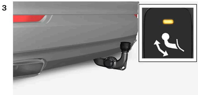
Poussez le crochet d'attelage en butée pour le fixer et le verrouiller. Le témoin reste allumé en orange.
