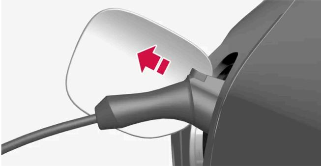
Débranchez le câble de recharge de la prise de recharge de la voiture, remplacez le cache de la prise et fermez la trappe.
