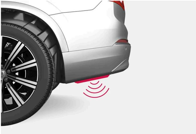
Pour activer l'ouverture ou la fermeture à l'aide du pied sur les voitures avec plaque de protection, le mouvement doit être effectué depuis le côté de la voiture. Une des clés de la voiture doit être détectable, à environ 1 mètre (3 pieds).
