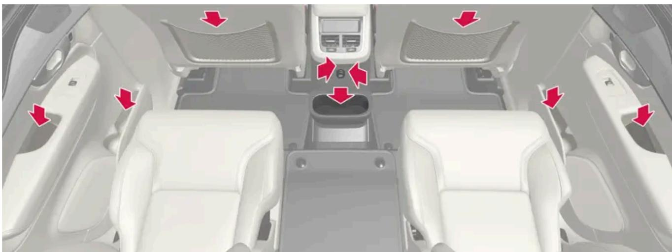
Compartiment de rangement dans le panneau de porte, porte-gobelets sur le plancher de console de tunnel, compartiment de rangement\* sur le dossier du siège avant et ports USB dans la console tunnel.
