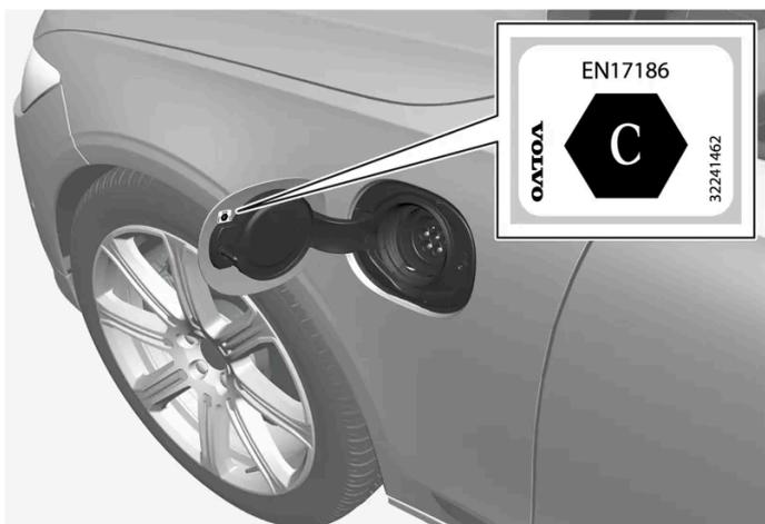
Un identifiant conforme à la norme CEN EN 17186 figure sur l'intérieur de la trappe de recharge.
