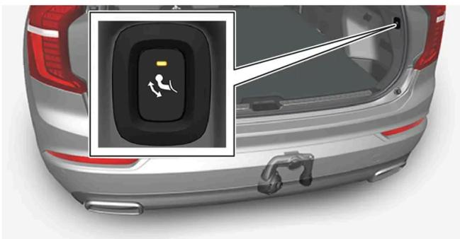
Ouvrez le hayon. Un bouton situé sur le côté droit à l'arrière dans le compartiment à bagages permet de sortir et de rentrer le crochet d'attelage. Un témoin sur le bouton doit s'allumer en orange pour permettre la sortie du crochet.
