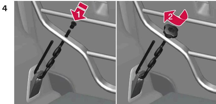
Fixez le crochet de l'étrier de fixation par dessous dans l'anneau d'arrimage de charge au niveau du plancher puis insérez la partie filetée par dessous dans l'ouverture de fixation inférieure de la grille de protection (1).
