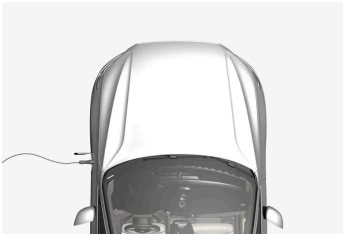
La batterie hybride est rechargée à l'aide d'un câble de recharge mais peut également être rechargée par les freinages légers et par le frein moteur en position de changement de rapport B. La batterie hybride peut également être chargée grâce au moteur à combustion de la voiture. La batterie de démarrage de la voiture est rechargée durant la recharge de la batterie hybride.
