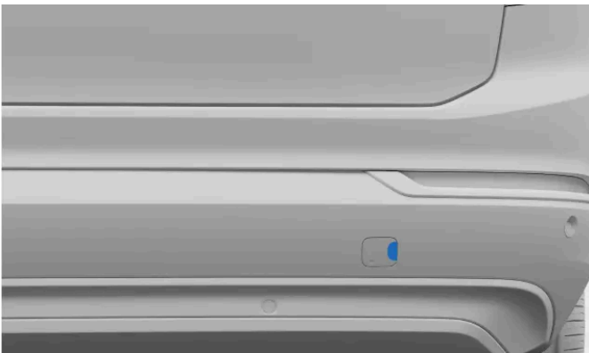
Cache de fixation d'anneau de remorquage arrière
