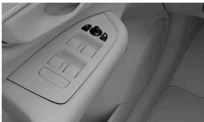
Commandes de réglage des rétroviseurs extérieurs
