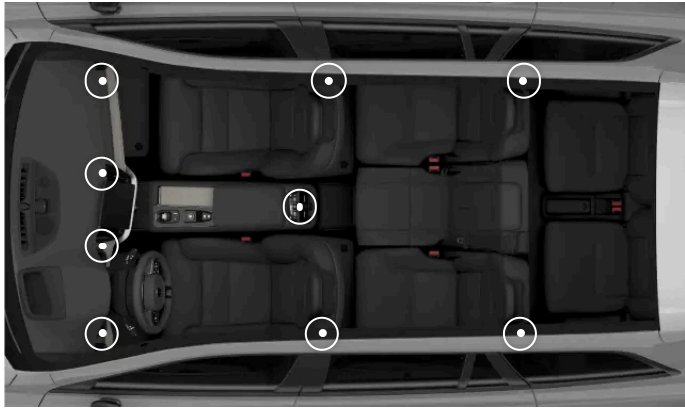
Position des buses de ventilation réglables
