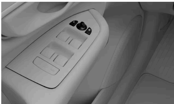
Commandes de réglage des rétroviseurs extérieurs
