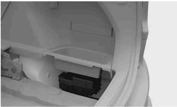
Emplacement de la boîte à fusibles
