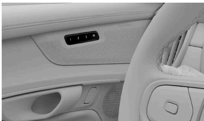
Emplacement des boutons de préréglages de siège
