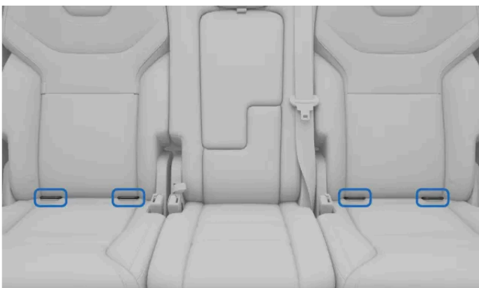
Position des points de fixation ISOFIX pour les sièges de la deuxième rangée
