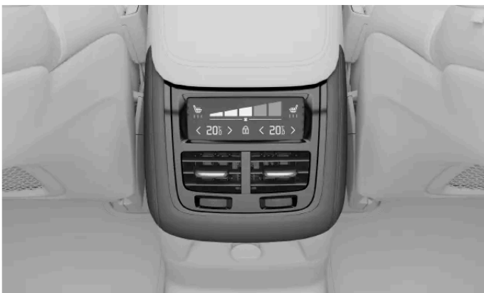
Commandes de climatisation dans la console de tunnel
