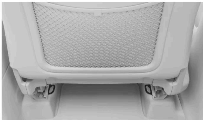
Les points de fixation de sangle inférieure se trouvent à l'arrière des rails au plancher des sièges avant.
