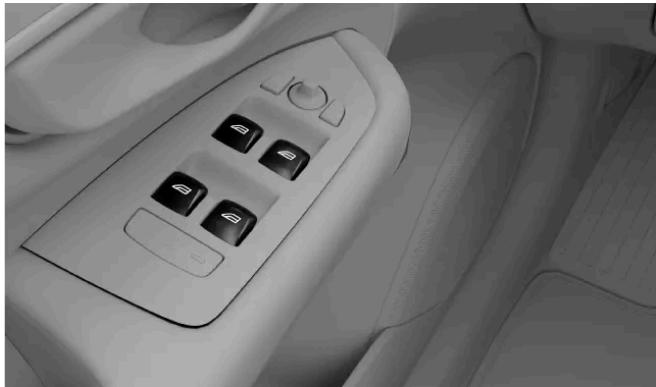
Utilisez les interrupteurs pour ouvrir ou fermer les vitres :
