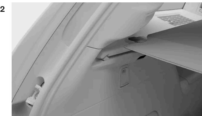
Soulevez les extrémités de la protection du cache-bagages dans le coude. Tenez la poignée et guidez la protection du cache-bagages hors des rainures supérieures. Cela permet à la protection de se rétracter automatiquement.
