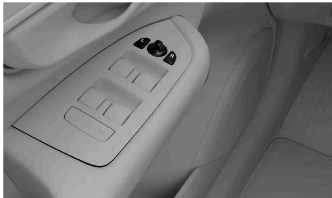
Commandes de réglage des rétrociseurs extérieurs
