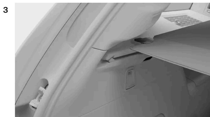
Faites glisser les extrémités de la protection du cache-bagages dans les rainures supérieures des panneaux latéraux.
