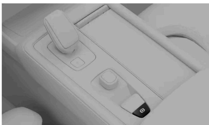
**1** Appuyez sur le bouton de Frein à l'arrêt sur la console de tunnel.
