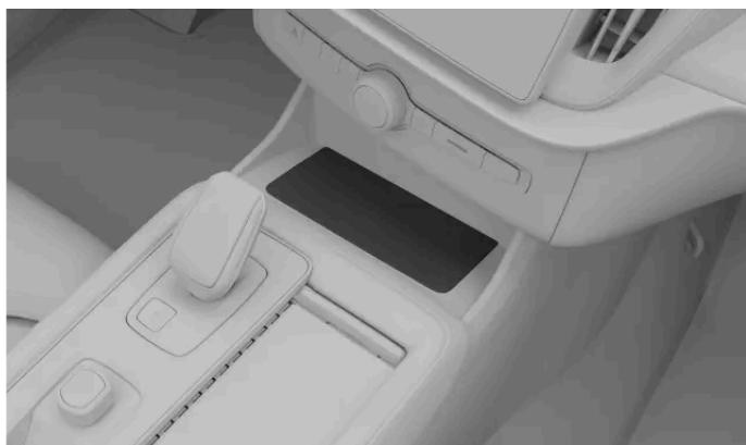
Pour utiliser le chargeur sans fil, votre appareil doit être certifié selon la norme Qi de recharge sans fil. Vérifiez également que la recharge sans fil est activée à la fois sur l'appareil<sup>[1]</sup> et sur le chargeur lui-même. Vous pouvez activer le chargeur à l'écran central.
