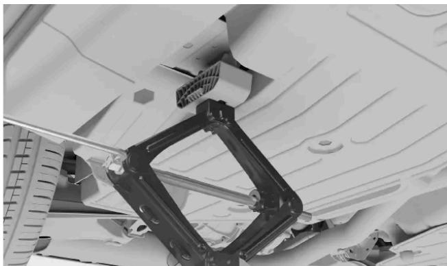
**8** Soulevez la voiture à une hauteur appropriée. Ne la soulevez pas plus que nécessaire pour les travaux à effectuer.
