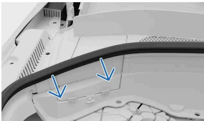
Le réservoir de liquide de refroidissement est situé dans le coin supérieur gauche du compartiment moteur, sous une trappe de panneau. Tirez le joint en caoutchouc vers le compartiment moteur pour accéder à la trappe.
