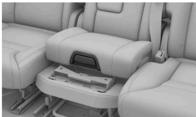
Tirez sur la poignée à l'avant du coussin du siège pour enfant pour déverrouiller le mécanisme.
