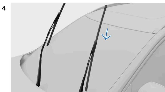
Vérifiez que le balai côté conducteur est plus long que celui du côté passager. Faites glisser le balai d'essuie-glace sur le bras d'essuie-glace. Vérifiez que la goupille du bras d'essuie-glace entre dans l'orifice du balai d'essuie-glace. Poussez le balai dans le bras d'essuie-glace jusqu'à ce qu'un déclic se fasse entendre.
