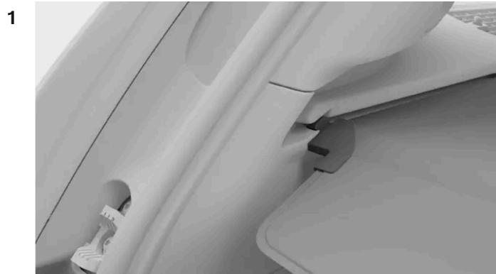
Soulevez et tirez l'extrémité de la protection du cache-bagages par la poignée pour la déverrouiller.
