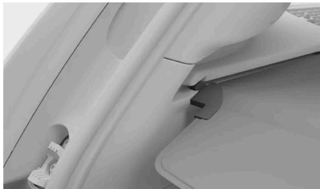
Guidez les extrémités du cache-bagages en position verrouillée dans les rainures.
