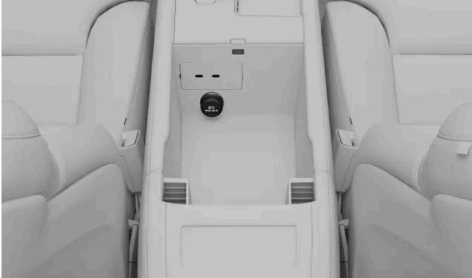
La prise électrique 12 V dans la console de tunnel
