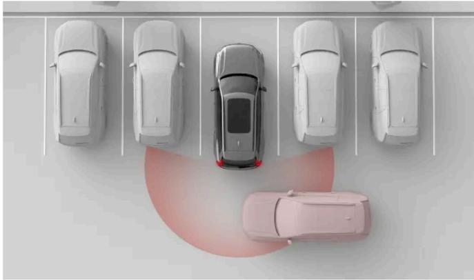
Les fonctions suivantes sont conçues pour réagir lorsque la voiture détecte un risque de collision en marche arrière.
