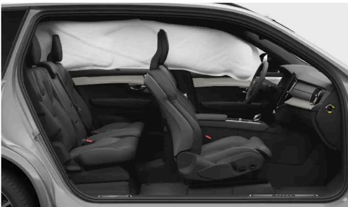
Les rideaux gonflables sont placés derrière des panneaux le long des bords du plafond, des deux côtés de la voiture. Les panneaux portent la mention IC AIRBAG.
