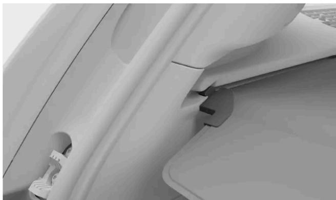
Soulevez et tirez l'extrémité de la protection du cache-bagages par la poignée pour la déverrouiller.
