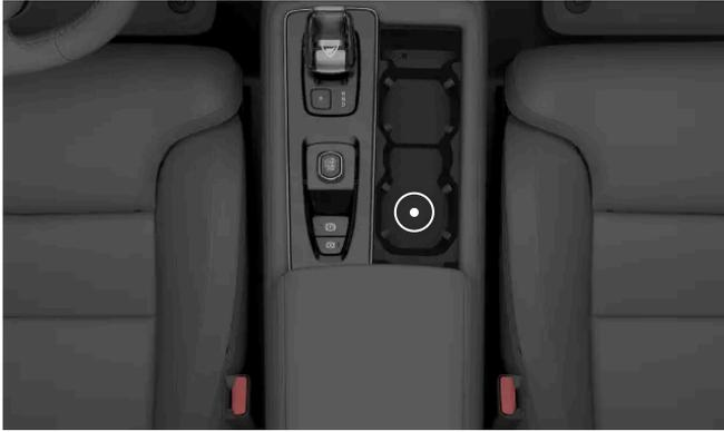
Emplacement du lecteur de secours à l'intérieur du porte-gobelet de la console de tunnel
