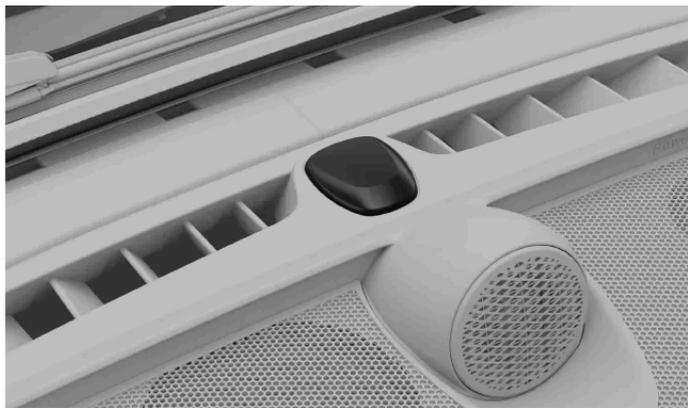
L'indicateur d'alarme est un voyant situé au centre du tableau de bord, devant le pare-brise. Le témoin confirme l'armement de l'alarme en clignotant en rouge.
