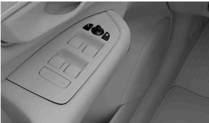
Commandes de réglage des rétroviseurs extérieurs
