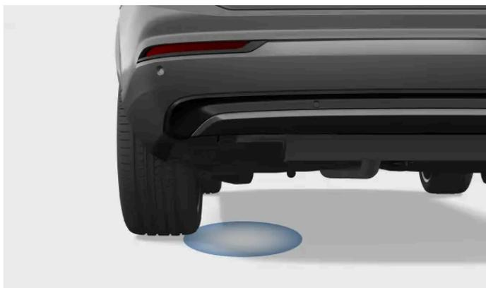
Le capteur détecte les mouvements sous le pare-chocs arrière. Tout mouvement détecté déverrouille le coffre.
