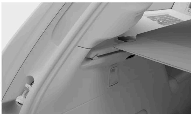
Soulevez les extrémités de la protection du cache-bagages dans le coude. Tenez la poignée et guidez la protection du cache-bagages hors des rainures supérieures. Cela permet à la protection de se rétracter automatiquement.
