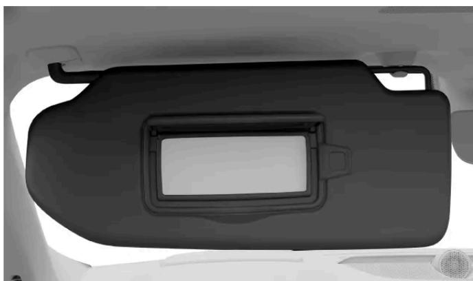
Les pare-soleils peuvent être abaissés et pivotés sur le côté si nécessaire.
