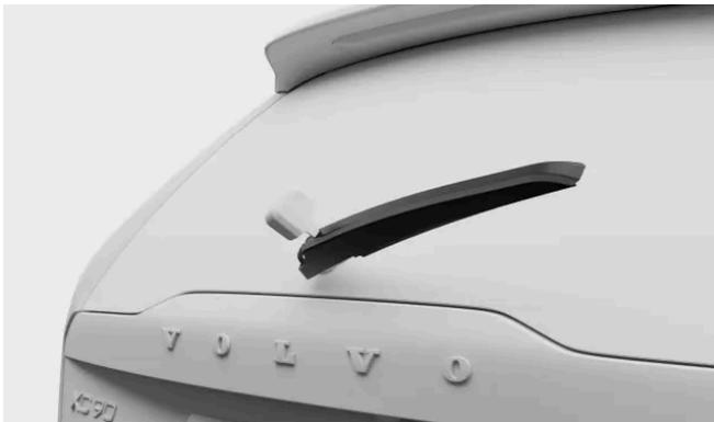
Agrippez le centre du bras d'essuie-glace et soulevez-le de la lunette arrière. Vous ressentirez peut-être une légère résistance à mi-chemin : il s'agit de la position de verrouillage. Le bras d'essuie-glace doit passer cette position de verrouillage pour ne pas se remettre en position sur la lunette arrière.
