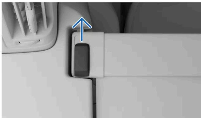
Les extrémités du cache-bagages comportent des boutons de verrouillage. Poussez vers l'avant le bouton de l'un des côtés et tenez-le tout en soulevant l'extrémité du cache-bagages. Procédez de la même façon pour l'autre extrémité du cache-bagages.
