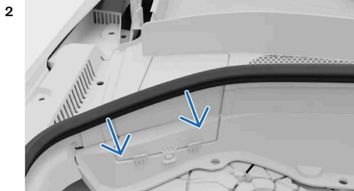
Le réservoir de liquide de refroidissement est situé dans le coin supérieur gauche du compartiment moteur, sous une trappe de panneau. Tirez le joint en caoutchouc vers le compartiment moteur pour accéder à la trappe.
