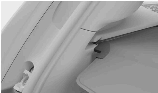
Guidez les extrémités du cache-bagages en position verrouillée dans les rainures.
