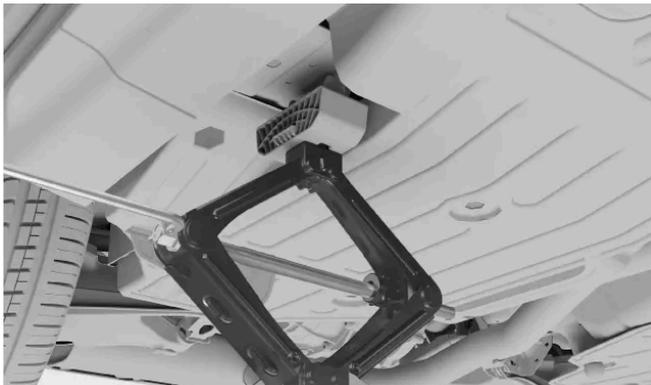
8 Soulevez la voiture à une hauteur appropriée. Ne la soulevez pas plus que nécessaire pour les travaux à effectuer.
