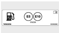
L'essence avec l'identifiant suivant peut être utilisée dans les voitures avec moteur à essence :
