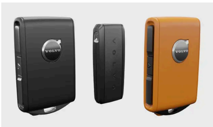
Clé standard, clé sans bouton et Care Key
