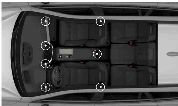
Position des buses de ventilation réglables
