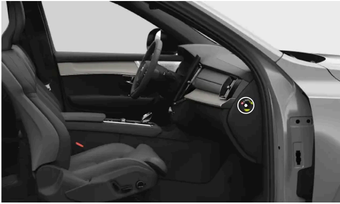
Position de l'interrupteur de coussin gonflable passager
