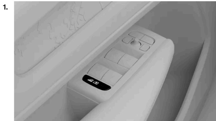
Θέση του κουμπιού για την κλειδαριά ασφαλείας παιδιών στο πάνελ της πόρτας
