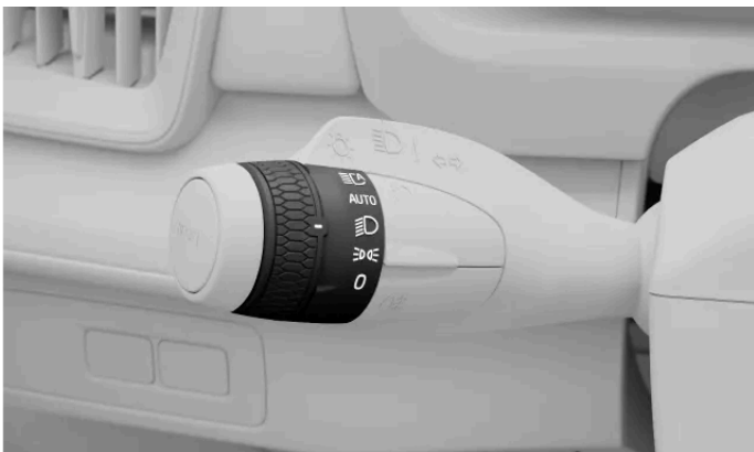
Σύμβολο των φώτων διασταύρωσης στον περιστρεφόμενο δακτύλιο του αριστερού μοχλοδιακόπτη
