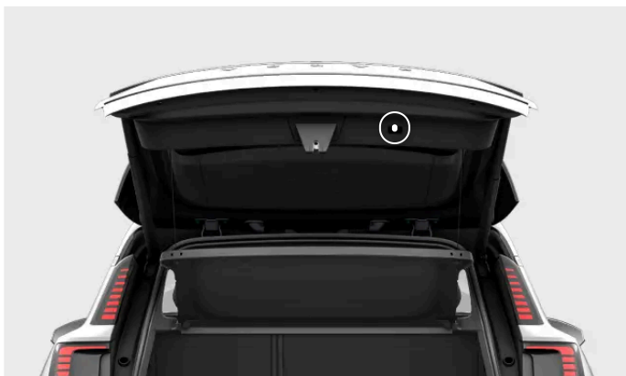
Θέση του κουμπιού κλεισίματος του πίσω καπό
