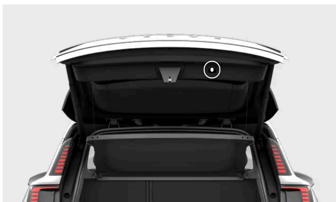
Θέση του κουμπιού κλεισίματος του πίσω καπό
