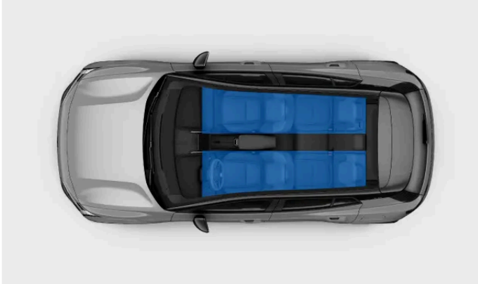
Διαθέσιμες ζώνες κλιματισμού.
