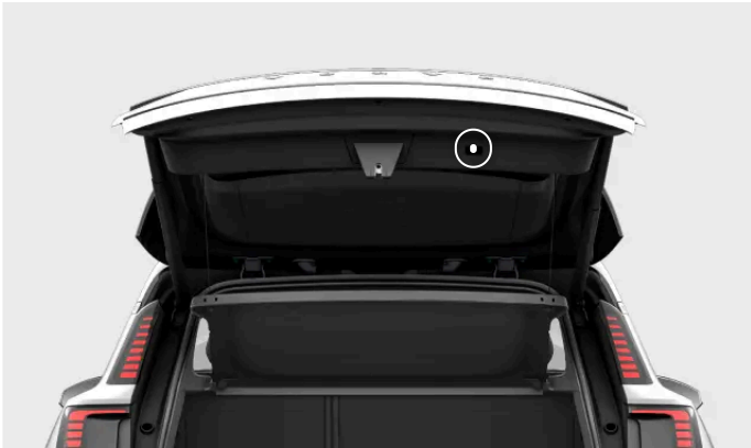
Θέση του κουμπιού κλεισίματος του πίσω καπό
