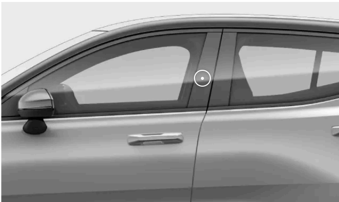
Θέση ανάγνωσης κλειδιού στην κολόνα της πόρτας του οδηγού
