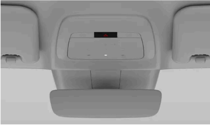
Θέση του κουμπιού των αλάρμ στην κονσόλα οροφής
