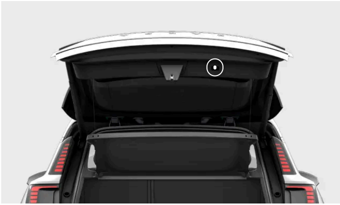
Θέση του κουμπιού κλεισίματος του πίσω καπό
