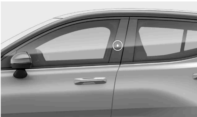
Θέση ανάγνωσης κλειδιού στην κολόνα της πόρτας
