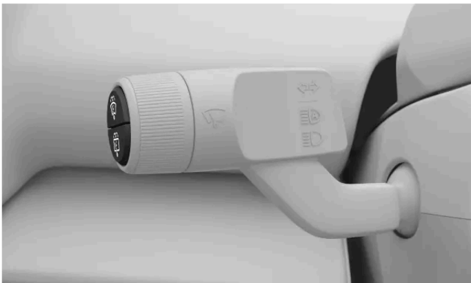
Κουμπιά για τους ψεκαστήρες στον αριστερό μοχλοδιακόπτη του τιμονιού.
