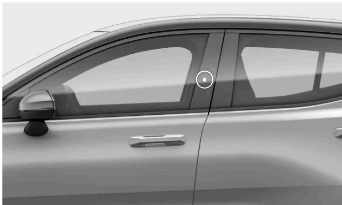
Θέση ανάγνωσης κλειδιού στην κολόνα της πόρτας
