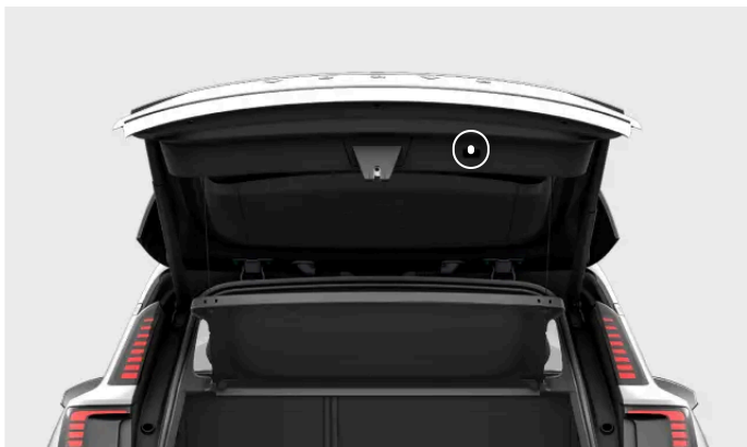
Θέση του κουμπιού κλεισίματος του πίσω καπό
