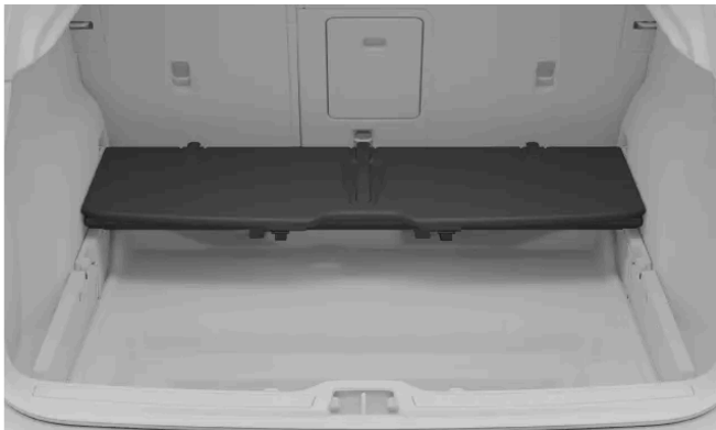
Αναδιπλωμένο κάλυμμα αποθηκευτικού χώρου.
