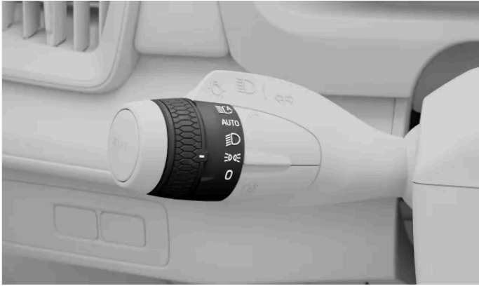
Σύμβολο των φώτων θέσης στον περιστρεφόμενο δακτύλιο του αριστερού μοχλοδιακόπτη
