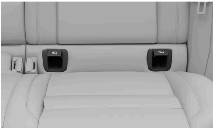
Θέσεις σημείων στερέωσης ISOFIX για τα πίσω ακριανά καθίσματα
