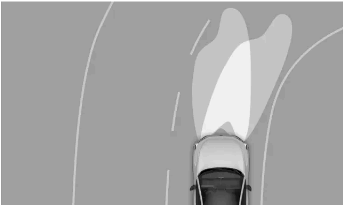
Τυπική λειτουργία των ενεργών φώτων στροφής
