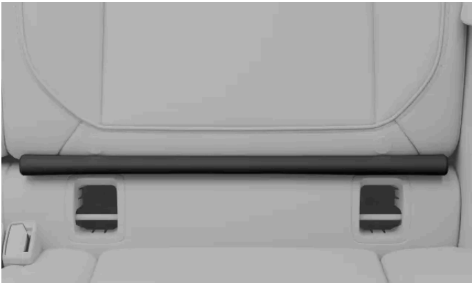
Διπλωμένο κάλυμμα ISOFIX, ενσφηνωμένο στο διάκενο πάνω από τα σημεία στερέωσης.
