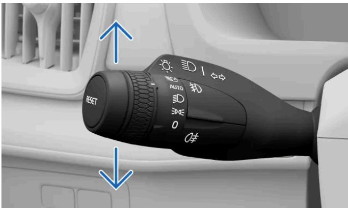
Τα φλας στον αριστερό μοχλοδιακόπτη
