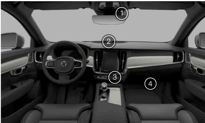
Αισθητήρες κλιματισμού στην καμπίνα
