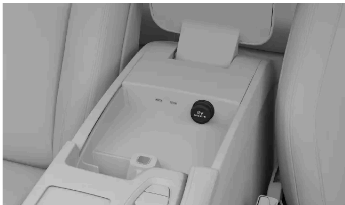
Ο ρευματοδότης 12 V βρίσκεται στην επιμήκη κονσόλα
