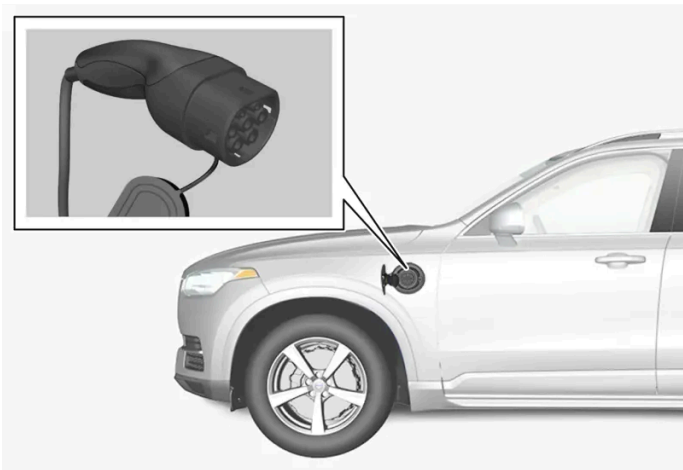
Λαβή καλωδίου φόρτισης και υποδοχή φόρτισης.
