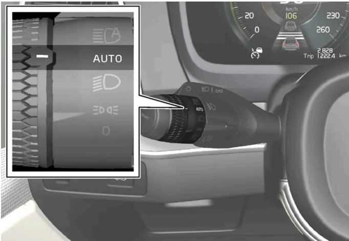
Περιστρεφόμενος δακτύλιος του μοχλοδιακόπτη στη θέση ΑΥΤΟ.
