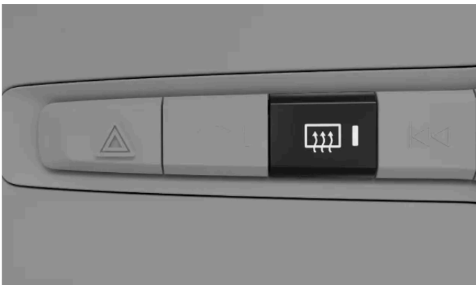
Κουμπί πίσω ξεπαγώματος στο πλαίσιο κουμπιών κάτω από την κεντρική οθόνη
