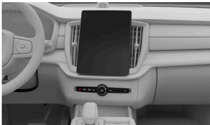
Κεντρική οθόνη και κουμπιά ξεπαγώματος στο πλαίσιο κουμπιών κάτω από την κεντρική οθόνη
