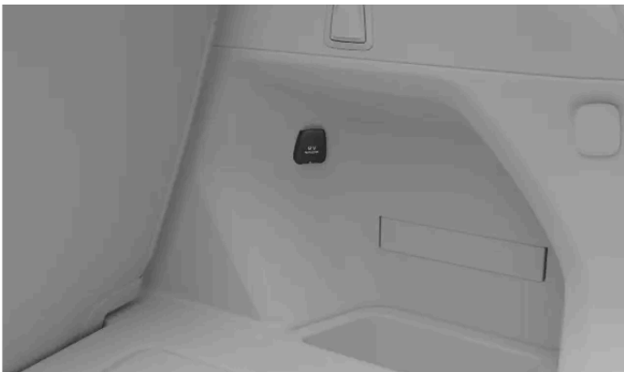
Ο ρευματοδότης 12 V βρίσκεται στη δεξιά πλευρά του χώρου αποσκευών.
