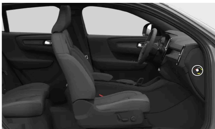
Posizione dell'interruttore dell'airbag passeggero
